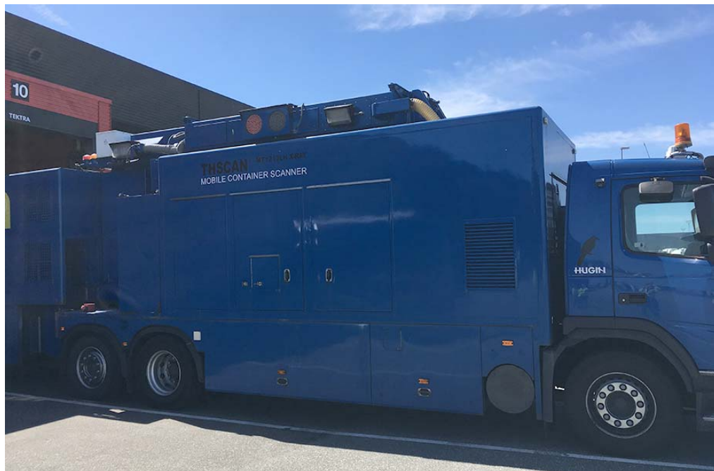
SKATs mobile scanner til brug ved kontrol af fx lastbilstransporter.
