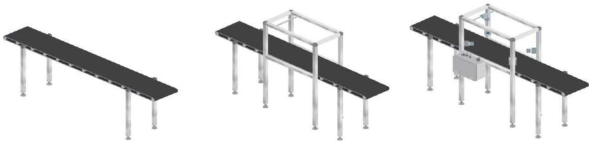
Steg 1. Ett befintligt transportband. Steg 2. Installering av ramverket. Steg 3. Installering av en/flera kameror.
