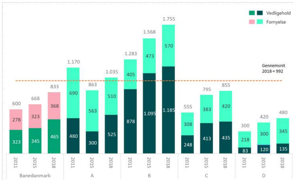
Figur 16 Sammenligning af vedligeholdelses- og fornyelsesomkostninger, t.kr/spor-km., ProRail & NS, Holland (2016, 2019)
