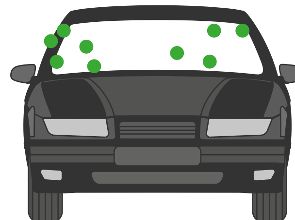
Figuren viser hovedets første kontakt med forruden/A-stolpen for 10 cyklister. 2 cyklister ramte næsten samme sted på forruden.
