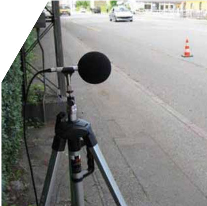
Figur 26 Eksempel på opstilling til SPB-måling i bygade (Statistical Pass-By)
