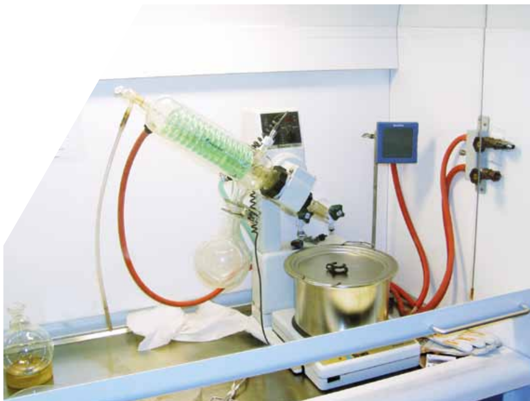
Figur 31 Rotation-sinddamper-opstilling til genindvinding af bindemiddel efter EN 12697-3
