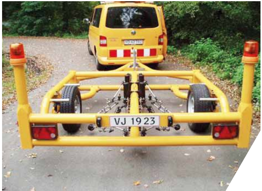
Figur 25 Traileren deciBella, der anvendes til måling efter CPX-metoden (Close Proximity)
