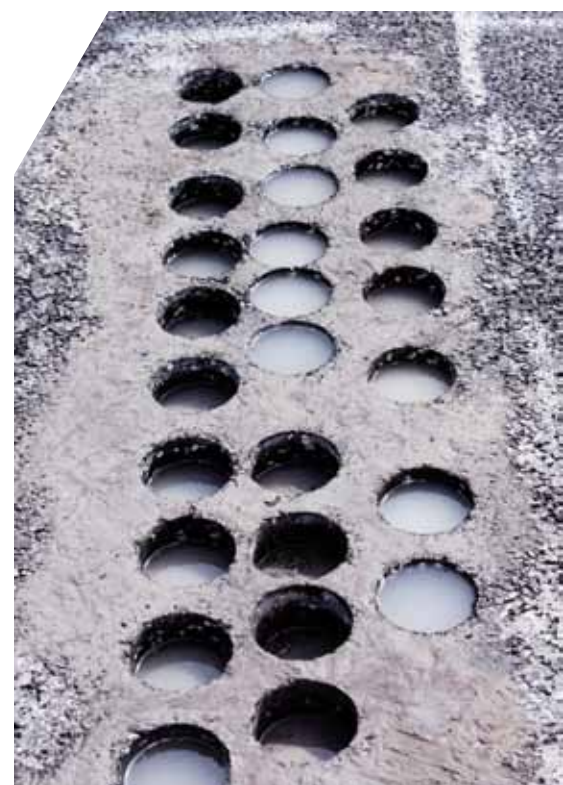
Figur 12 Opboring af borekerner fra en af belægningstyperne op rastepads Himmerland Øst (Foto: Colas Danmark A/S)
