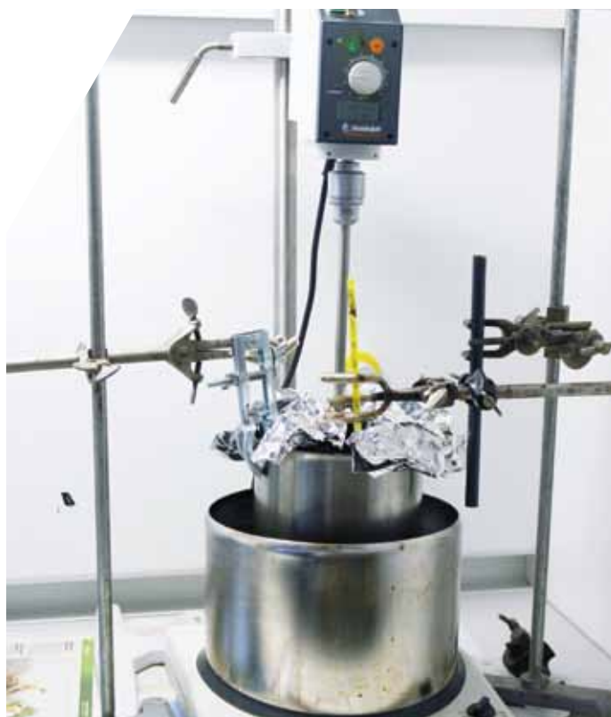
Figur 4 Opstilling til fremstilling af ROAD+ modificeret bindemiddel efter den våde proces
