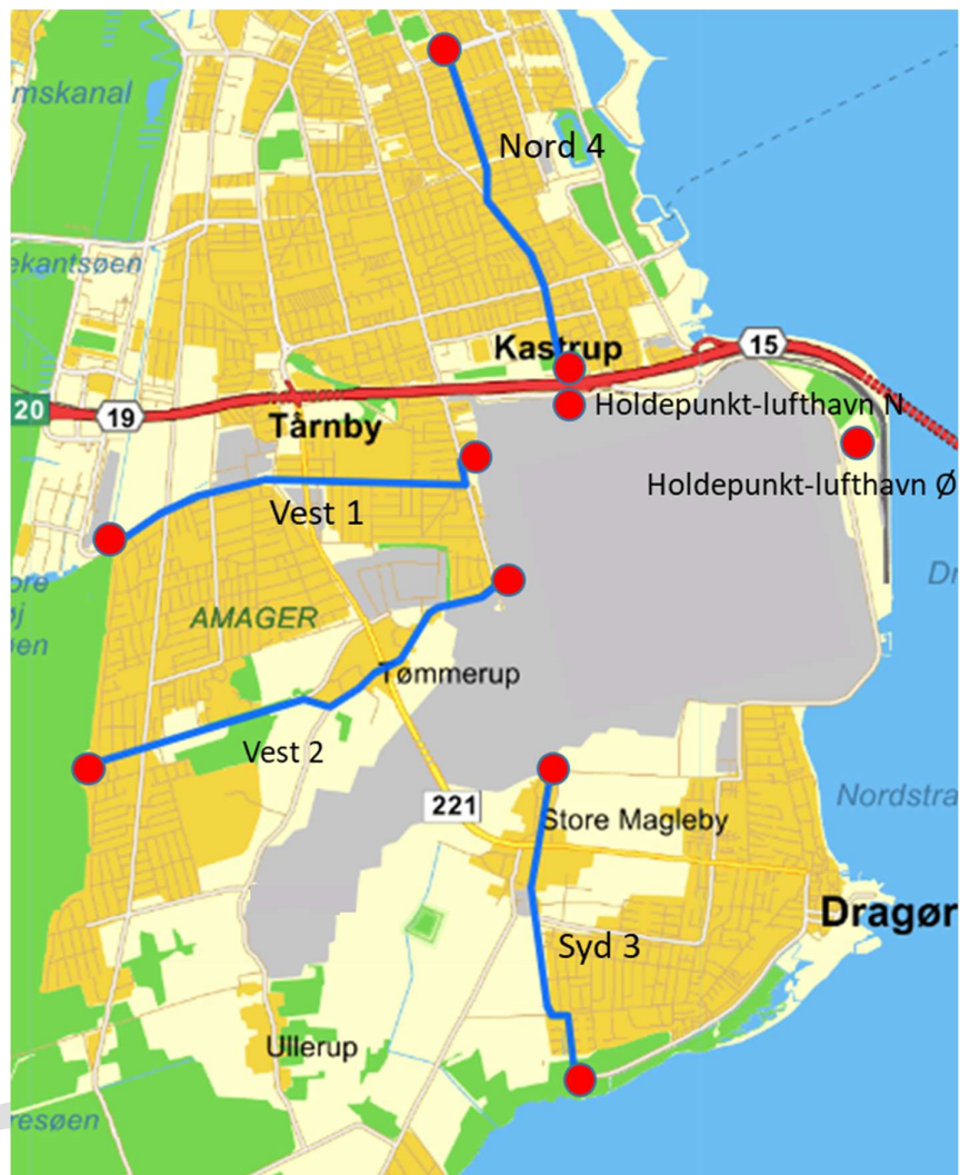
Figur 2.1. Skitse af måleruten, som gennemkøres 52 gange i løbet af måleperioden. De røde punkter angiver de 15-minutters holdepunkter, hvor bilen holder stille. De blå streger angiver transekterne, hvor ændringerne i luftkoncentrationerne af ultrafine partikler måles, mens målebilen kører hen mod eller væk fra selve lufthavnsområdet. Der er holdepunkter for hver ende af de fire transekter og to ekstra holdepunkter. Det ene af disse er placeret mellem lufthavnen og motorvejen i forlængelse af det nordlige transekt (Holdepunkt-lufthavn N). Det andet er placeret øst for lufthavnen (Holdepunkt-lufthavn Ø).
