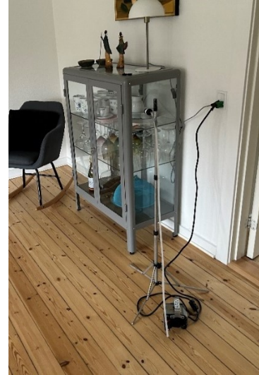
Billede 4—29. Eksempel på kontrol af rengøringsstandard med stationær luftmåling efter sanering en bolig.
