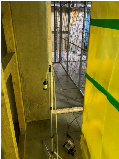
Billede 4—27. Eksempel på kontrol af rengøringsstandard med stationær luftmåling efter sanering af en kælder
