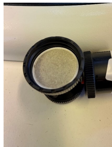
Billede 5—3. Filter fuldstændig dækket af støv.
