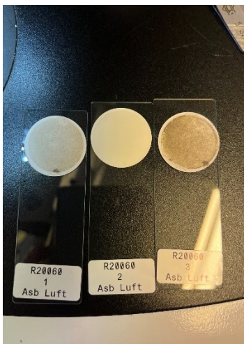
Billede 5—1. Forskel i støvmængden på stationære filtre
