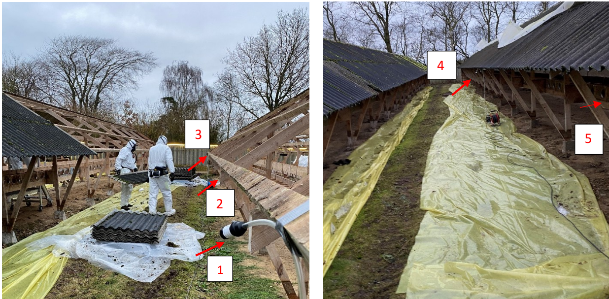
Billede 4—18. Placering af stationære målinger på minkfarm projekt 2. Tre målinger er placeret langs den ene side af taget hvor arbejdet foregik og to langs den anden side (røde piller).
