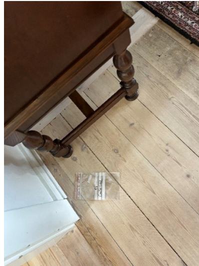
Billede 4—28. Eksempel af kontrol af rengøringsstandard med geltapeprøver efter sanering af en bolig.
