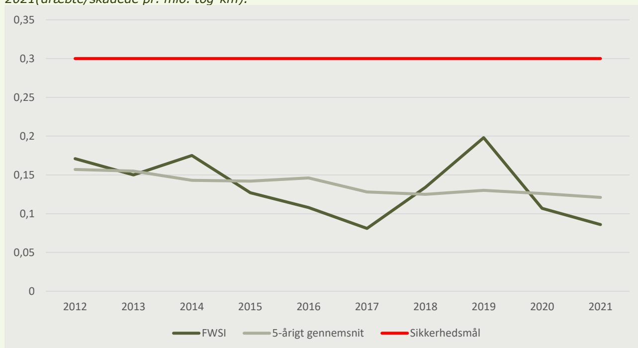
Figur 4.19: Overholdelse af det nationale sikkerhedsmål målt på alvorlige personulykker 2012-2021 (dræbte/skadede pr. mio. tog-km).
