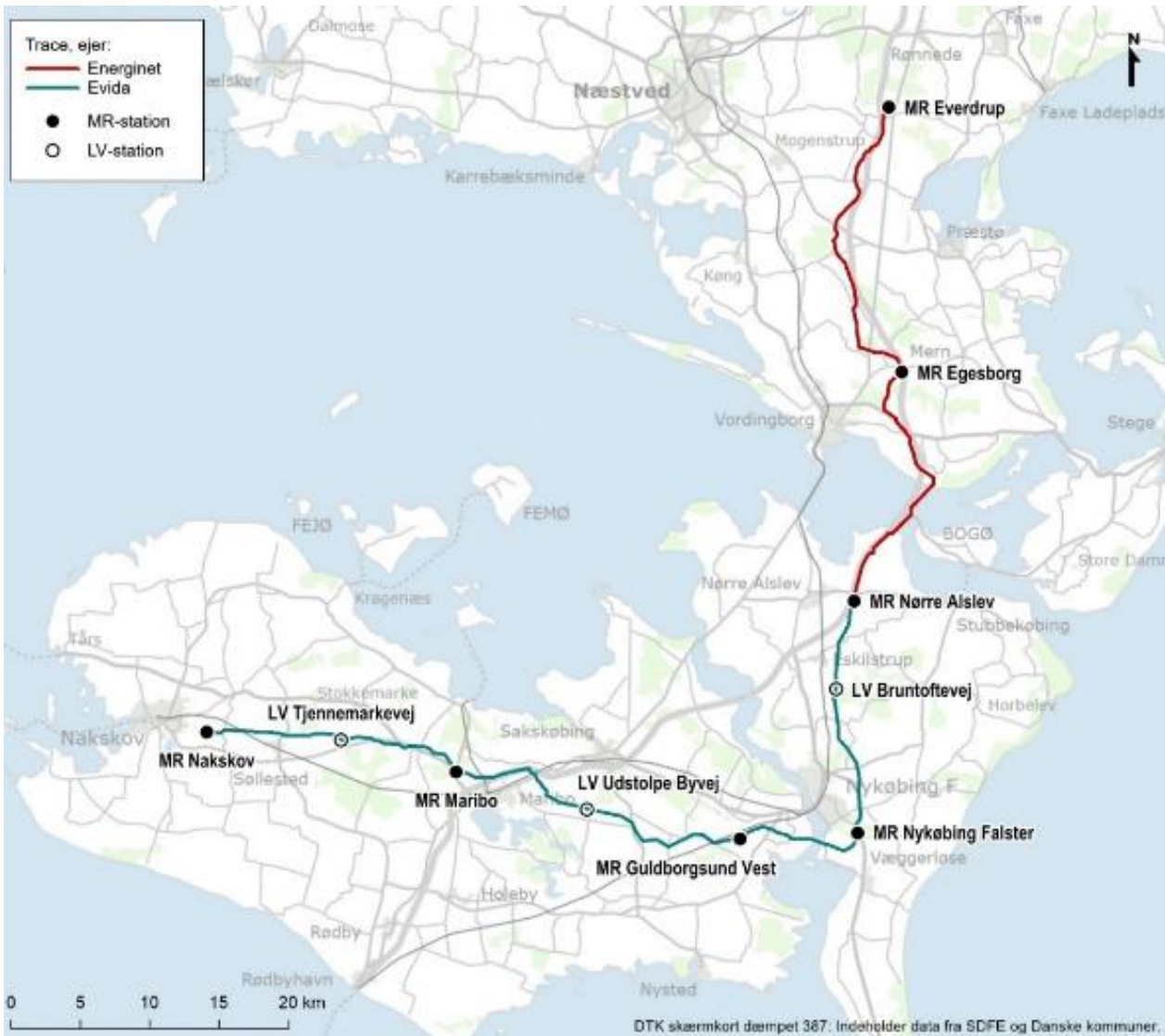
Figur 17. Gasrørledning til Lolland og Falster
