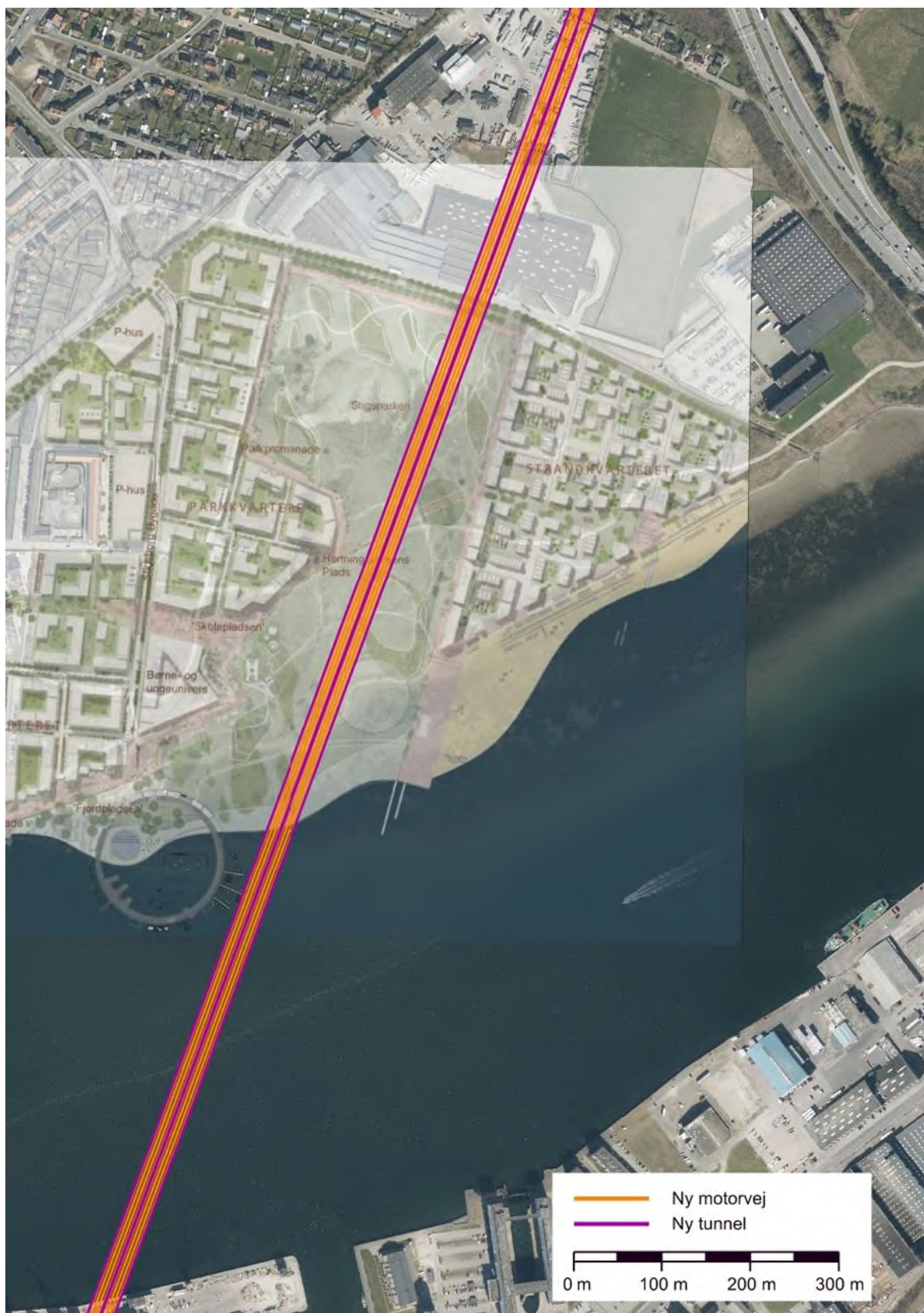
Kort over Ådalstunnelens linjeføring under Stigsborg Brygge og Limfjorden. Fremtidsplanen for Stigsborg Brygge er afbilledet. Her ses det, at der ikke er planer om at opføre bebyggelse på arealet, hvor linjeføringen for Ådalstunnelen forløber.
