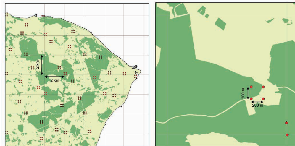
Figur 0.1. Design af Danmarks Skovstatistik. Grupper på fire prøveflader i hjørnerne af et 200 x 200 m kvadrat er udlagt i et systematisk net på 2 x 2 km.
