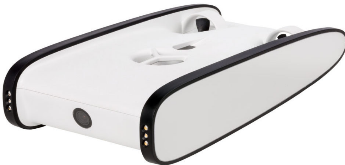
Figur 8-1. Det anvendte ROV-system ved de visuelle verifikationer og de biologiske undersøgelser: Trident fra SOFAR.
