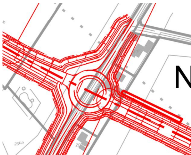
Figur 4-20 Rundkørsel ved Ridumvej. Udsnit fra tegning -1048.
