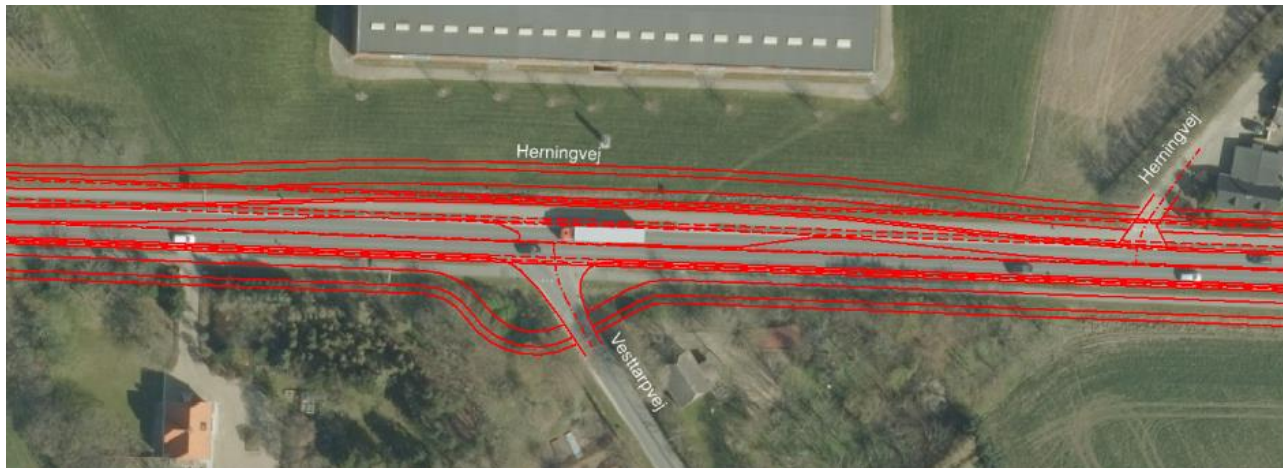
Figur 4-12 T-kryds ved Vesttarpvej. Fra vejteknisk beskrivelse
