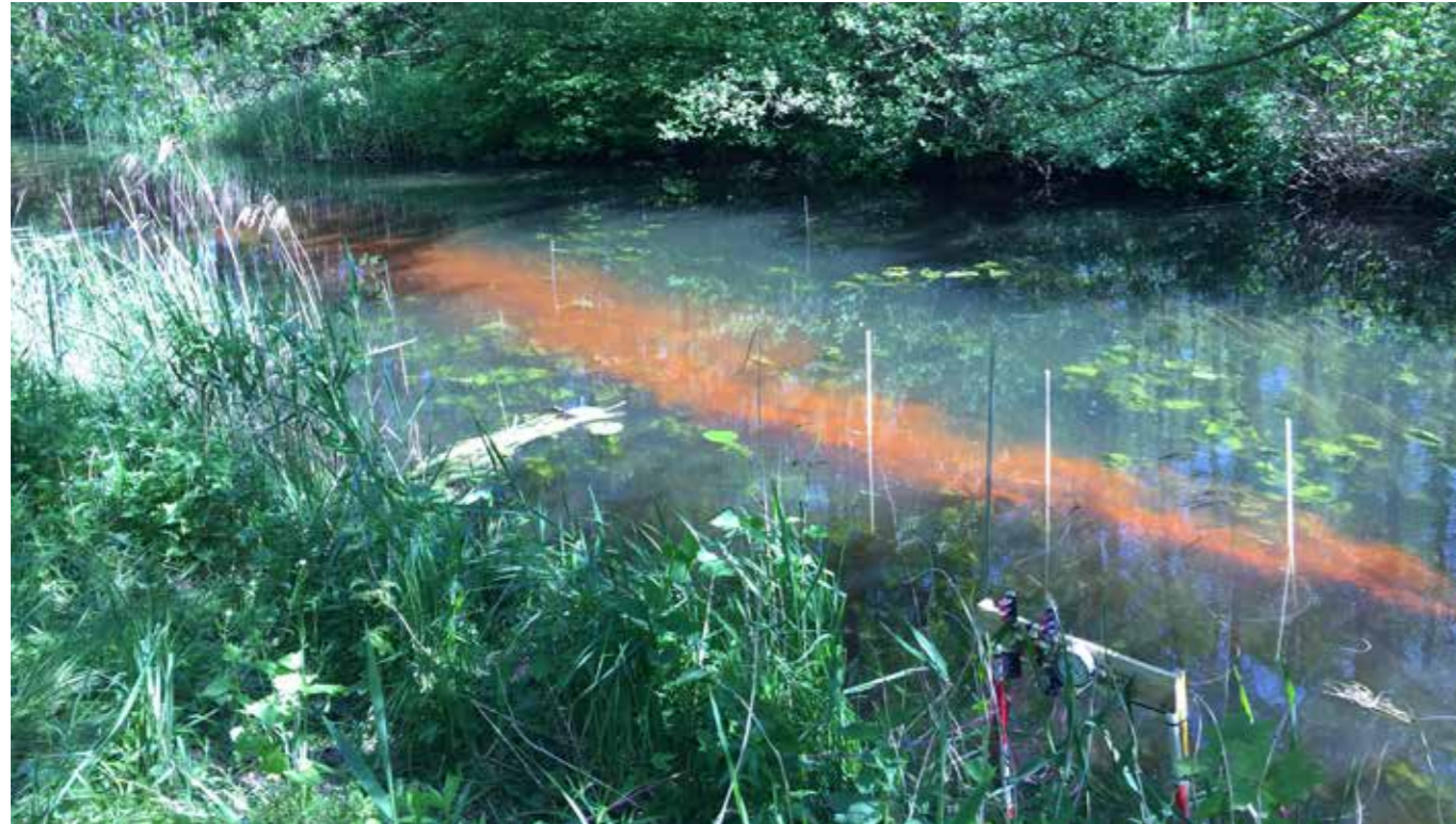
Sporstoffsøg i Mølleåen ved Raadvad. Forsøget viser, hvordan en jordforurening via grundvandet kan påvirke åen. Når forureningen er trængt ud i åen, vil den fortyndes og spredes med det strømmende vand.
