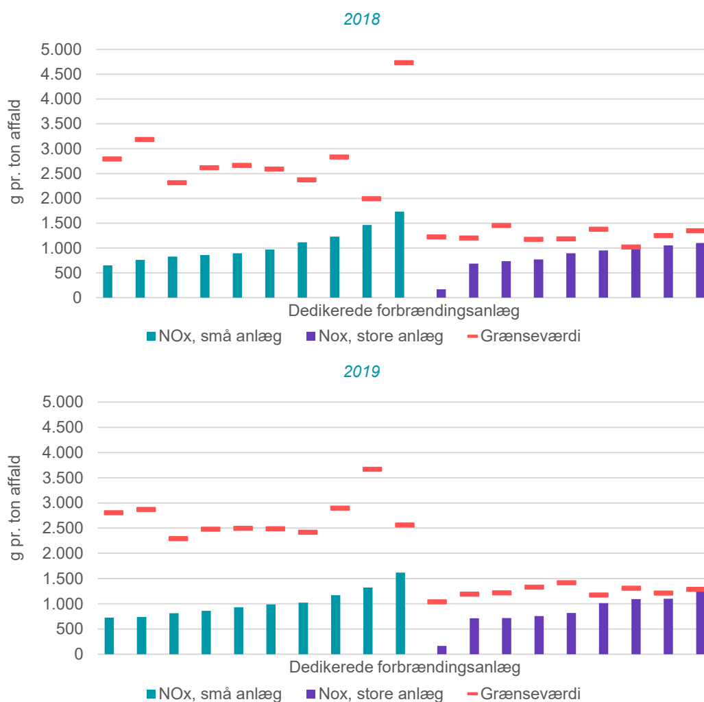
Figur 20a: Udledning af NO x , der måles kontinuerligt i g pr. ton affald, 2018 og 2019 (dedikerede forbrændingsanlæg)
