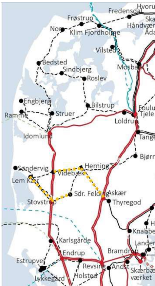
Figur 1: Kort over projektet. Nye 150 kV kabelforbindelser er vist med orange, stiplede linjer. Kilde: Energinet.
