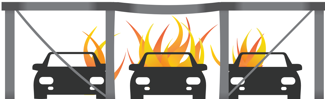
Figur 2. Brandsikkerheden for åbne parkeringshuse i ubeskyttet stål er hidtil baseret på en antagelse om, at konstruktionen kun opvarmes lokalt, således at belastning kan omforderes til naboelementer, der ikke er varmepåvirkede.
