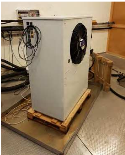
Prototype af luft-vand-varmepumpe med propan-kølemiddel bliver testet i klimakammer. Foto: Teknologisk Institut.
