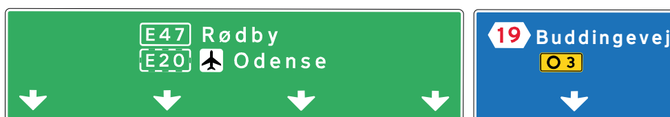
Figur 5.25 Nye portaltavler med nedadrettede pile, som gør det entydigt for trafikanterne hvor de skal placere sig.
