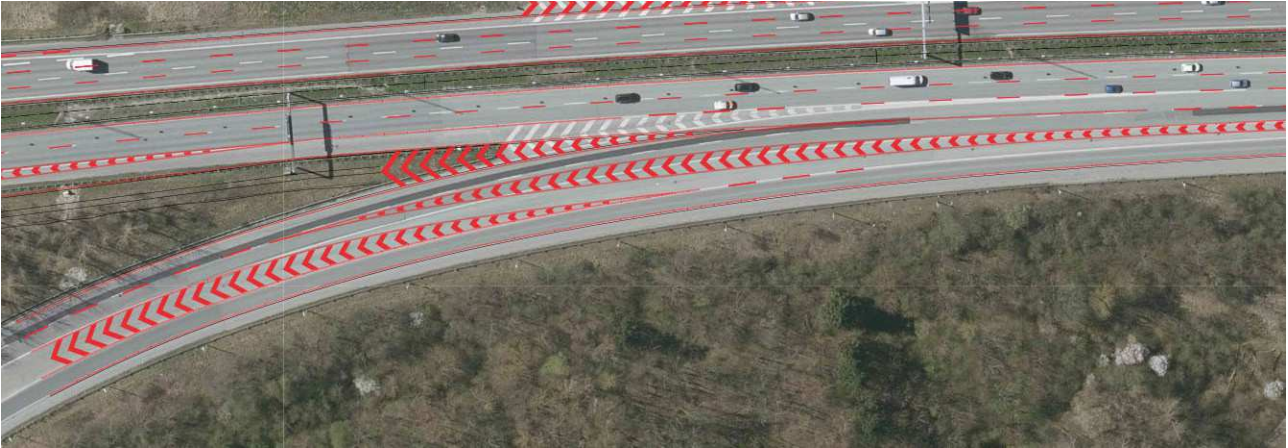
Figur 5.16 Sammenfletningen mellem Holbækmotorvejen og Motorring 3. Der kommer tre spor fra Holbækmotorvejen, som fordeler sig med to fra vest og et fra øst.
