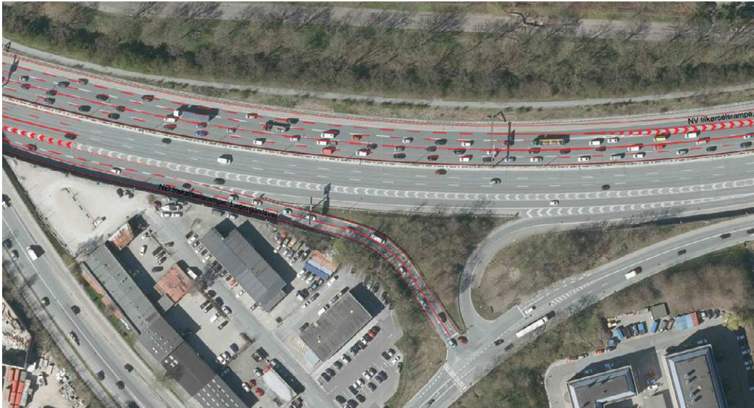
Figur 5.9 Fem spor mellem tilkørslen Lyngby Omfartsvej og frakørslen Nybrovej i sydgående retning, hvor trafikken er opdelt i lokal og regional trafik - tre spor til lokaltrafik og flettemanøvrer samt to spor til gennemkørende trafik. Både parallelsforsafmærkning og "landevejsafmærkning" er anvendt.
