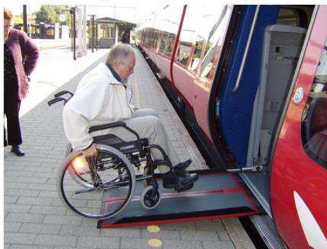
Halv-automatisk rampe i togets dørkarm i 112 S-tog. Rampen betjenes af lokoføreren og tillader os som passagerer med handicap at kunne tage toget spontant til 84 S-togsstationer ud af de 87 i alt.
