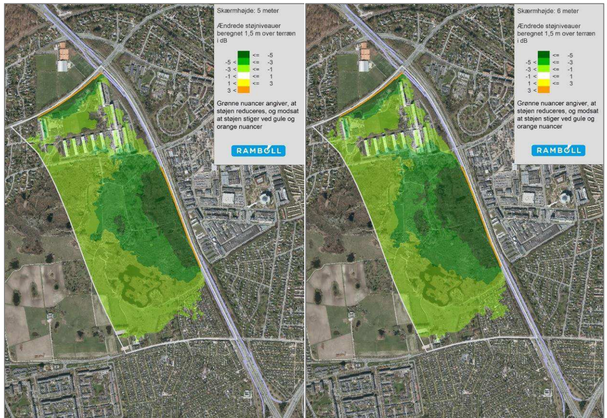
Figur 12 Differenskort, skærmhøjde 5 meter.
