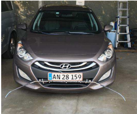
Illustration 3: Plume chasing bilen benyttet i Færdselsstyrelsens plume chasing projekt i 2020. Kilde: Færdselsstyrelsen.
