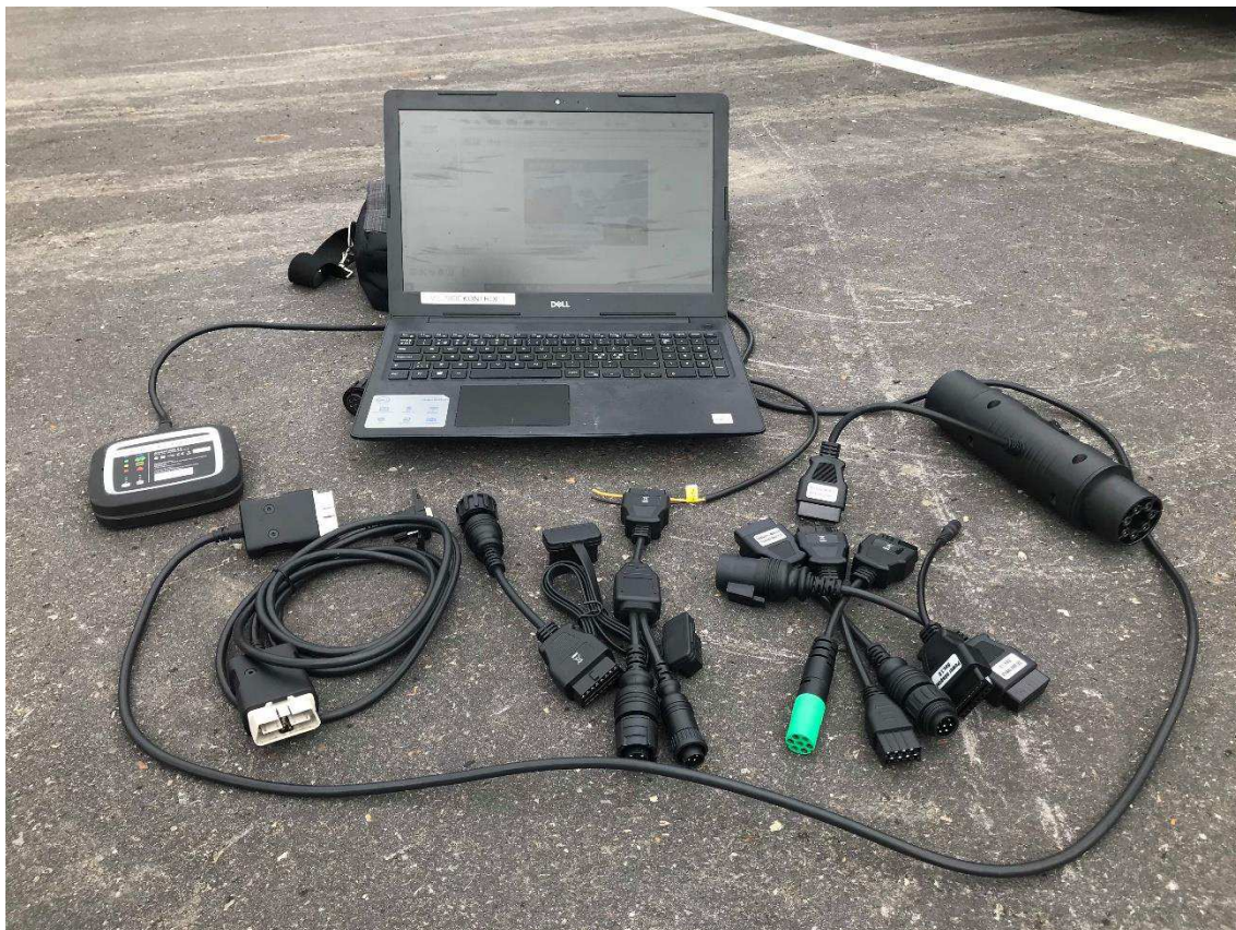
Illustration 5: Eksempel på OBD-udlæsningsudstyr - Kilde: Færdselsstyrelsen.
