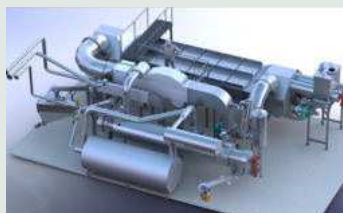
3D tegning af et AquaGreen damp-tørring- og pyrolyseanlæg til behandling af spildevandsslam fra 50.000 personer. Disse anlæg etableres hos Odsherred Forsyning og VandCenter Syd (Nordfy) i løbet af 2021.
