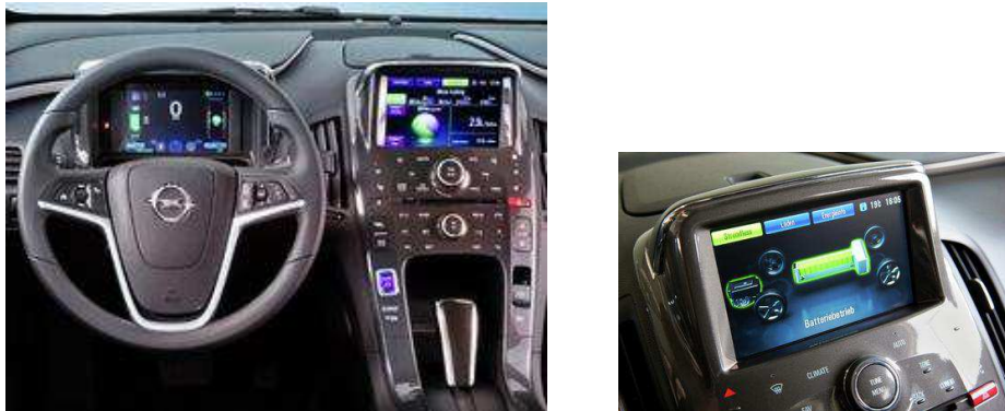
Instrumenter i plugin hybridkøretøjer, med den store kraftfordelingskærm typisk placeret centralt i instrumentbordet. Dette eksempel er fra plugin hybriden Opel Ampera.
