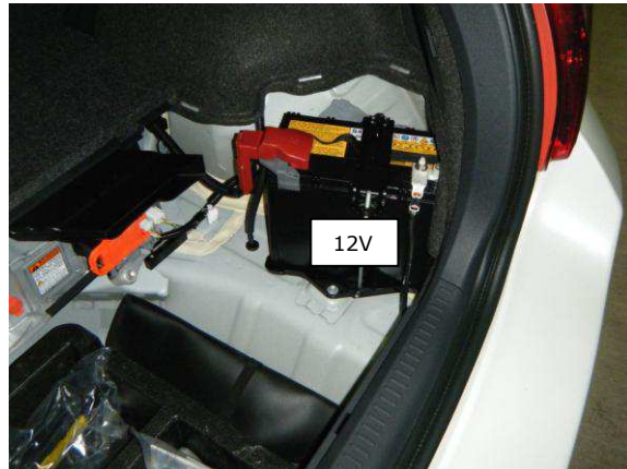
Et eksempel på placeringen af et mindre fremdriftsbatteri i et hybridkøretøj. 12 volts batteriet er i dette tilfælde også placeret i bagagerummet i bagerste højre hjørne.
