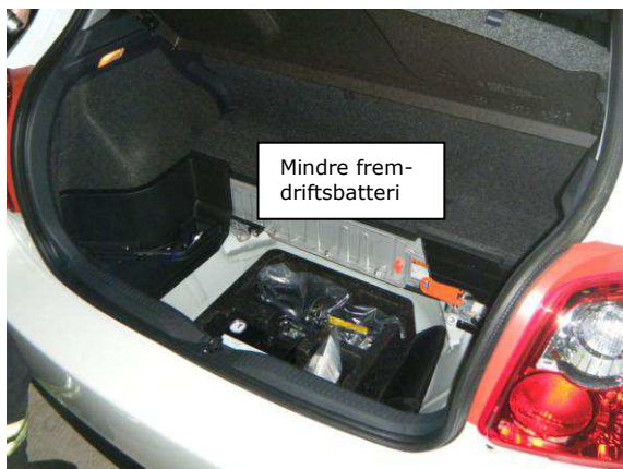
Et eksempel på placeringen af et mindre fremdriftsbatteri i et hybridkøretøj. 12 volts batteriet er i dette tilfælde også placeret i bagagerummet i bagerste højre hjørne.
