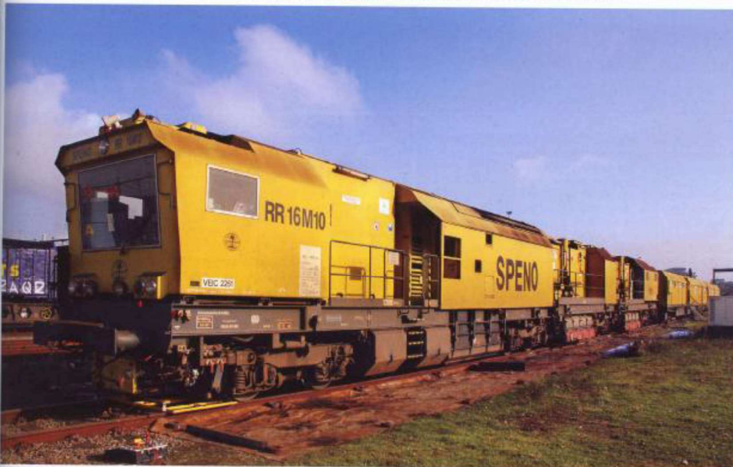
Ook werkmaterieel, waaronder deze Speno-slijptrein, moet zijn voorzien van ATBE-apparatuur. De foto is gemaakt bij het kalibreren van de installatie. Het testframe dat wordt gebruikt om de ATB-signalen te simuleren is zichtbaar vlak voor de eerste wielas. Ronald Hagenaar, Lloyd's Register
