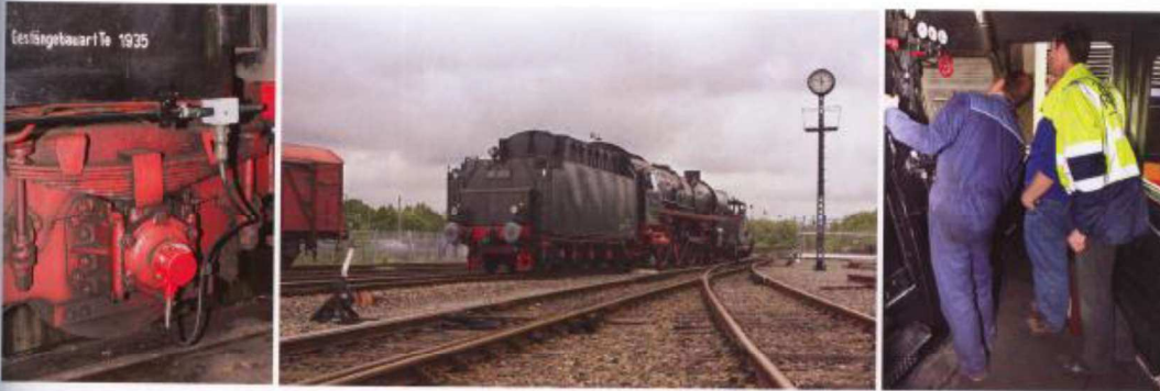
Llinks: de kilometerteller is gemonteerd op de eerste as van de tender. De kabel wordt via de lasdoos verbonden met de centrale apparatuur. Midden: met behulp van rangeerloco C4-03 wordt de 01 1075 naar buiten gereden en de waarde die de snelheidsmeter van de loc aangeeft vergeleken met die welke door de ATBE wordt gemeten. Deze moeten uiteraard hetzelfde zijn. Rechts: terwijl de computer instructies geeft aan het systeem kijken de technici van Lloyd's en de SSV toe hoe de reminstallatie van de stoomloc reageert. Bij het testen van het remsysteem wordt, omdat de loc niet onder stoom staat, gebruik gemaakt van perslucht.
