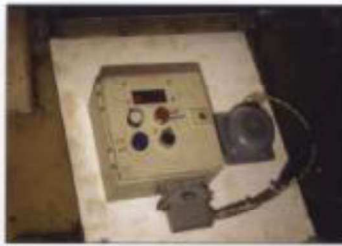
Het bedieningstableau in het machinistehuis. Rechts de gang die geactiveerd wordt wanneer een seinbeeld met snelheidsverlichtering wordt getoond. Op de grote kast zitten een digitale snelheidsmeter, de blauwe lamp die aangeeft dat de machine op een traject rijdt zonder ATB, de witte lamp van bediende remingreep, de rode lamp van ATB-remingreep en een rijrichtingschakelaar.
