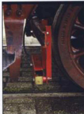
De ATB-opneemspeelen zijn bij stoomloc 65 018 tussen de baanschulver en de wielen gemonteerd. Omdat de wielen van een stoomloc geen retourstroom geleiden en daardoor geen elektromagnetische verstoring kunnen veroorzaken -zij zijn dus helemaal schoon- is montage op deze plek geen probleem. Bij tractievoertuigen die wel een retourstroom voeren moet de afstand tussen opneemspoel en wiel minstens 1 tot 1,5 meter bedragen.
