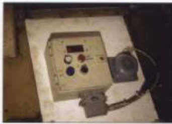
Het bedieningstabelau in het machinistehuis. Rechts de gang die geactiveerd wordt wanneer een seinbeeld met snelheidsverlichtering wordt getoond. Op de grote kast zitten een digitale snelheidsmeter, de blauwe lamp die aangeeft dat de machine op een traject rijdt zonder ATB, de witte lamp van bediende remingreep, de rode lamp van ATB-remingreep en een rijrichtingschakelaar.
