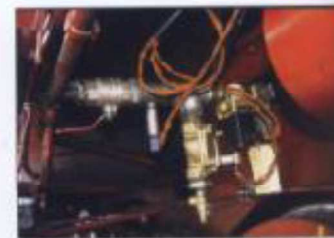
Op de achterste as van de 65'er is een gekijkte snelheidsmeter, type Gassler gemonteerd. Deze neemt de snelheid van de loc nauwkeuriger op dan de oorspronkelijke snelheidsmeter.
