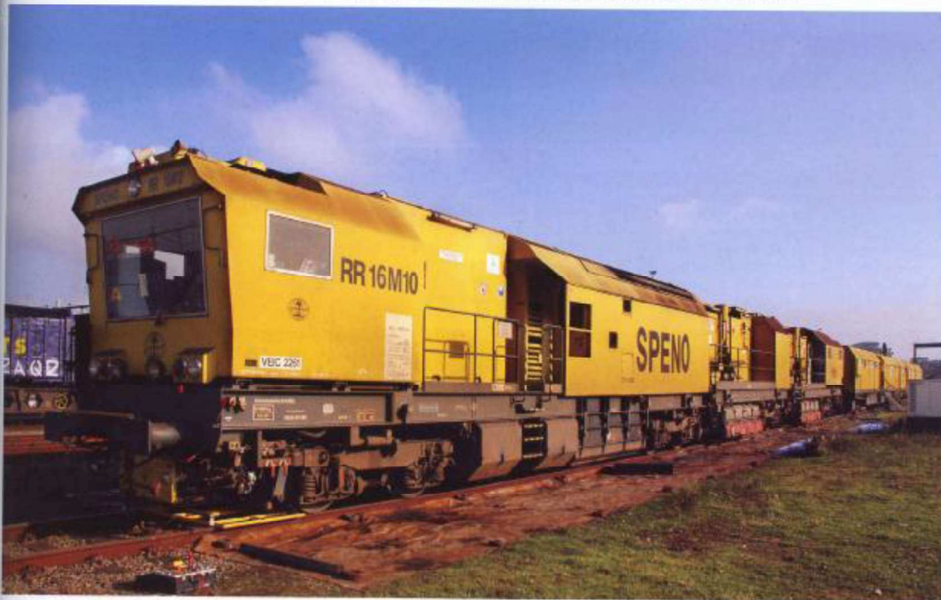
Ook werkmaterieel, waaronder deze Speno-slijptrein, moet zijn voorzien van ATBE-apparatuur. De foto is gemaakt bij het kalibreren van de installatie. Het testframe dat wordt gebruikt om de ATB-signalen te simuleren is zichtbaar vlak voor de eerste wielen. Ronald Hagenaar, Lloyd's Register
