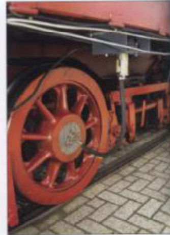
Op de achterste as van de 65'er is een gekijkte snelheidsmeter, type Gassler gemonteerd. Deze neemt de snelheid van de loc nauwkeuriger op dan de oorspronkelijke snelheidsmeter.
