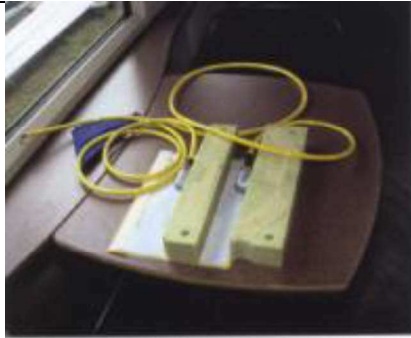
Zo zien de ATB-opneempoezen er uit in ongemonteerde toestand. Zij lijken niet meer dan een paar kunststofblokken. In werkelijkheid zijn zij in staat om de ATB-signalen die in de spoorstaven geïnjecteerd worden op te nemen en te vertalen in opdrachten voor de machinist.
