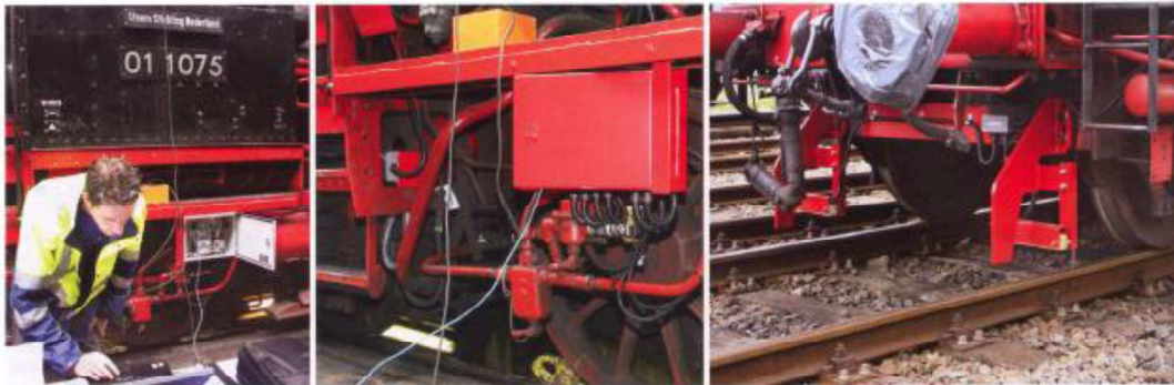
Links: Ronald Hagenaar van Lloyd's Register kalibreert met behulp van zijn computer de ATBE-installatie van SSN-loe 01 1075. Deze is ingebouwd in het geopende kastje; 5 mei 2009. Midden: zo zit de centrale apparatuurkast er in gesloten toestand uit. Deze valt nauwelijks op. Uit de kast lopen een aantal kabels en leidingen naar de diverse opnemers, kleppen en de snelheidsmeter. Kunt u zich voorstellen dat het een hele klus geweest is om te bedenken hoe een en ander netjes en zo onopvallend mogelijk aangebracht kon worden? Rechts: de spoelen voor het opnemen van de ATB-signalen op de tender van loe 01 1075. Deze moeten vóór de voorste wielen zijn aangebracht.
