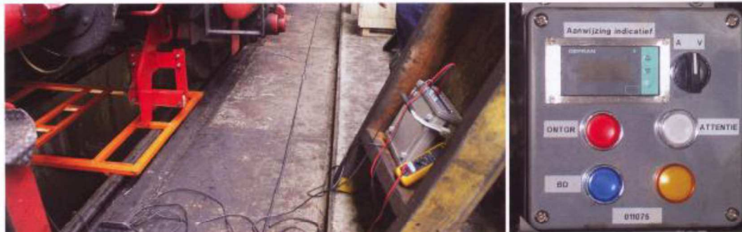
Links: het oranje frame dat op de rails ligt genereert, met behulp van de grijze kast die rechts zichtbaar is en codegever wordt genoemd, ATB-signalen die door de opneemspeel worden gelezen en doorgestuurd naar de centrale ATBE-unit. Dit frame wordt gebruikt op plaatsen waar geen ATB-signalen door de rail kunnen worden gestuurd om ze met een bekende stroomsterkte voor de kalibratie te simuleren. Rechts: de bedieningskast voor ATBE van loc 01 1075 zoals deze bij de plaats van de machinist is aangebracht. Linksonboven zit een digitale snelheidsmeter, daarnaast een knop met de keuze vooruit of achteruit, om de relevante opneemspeel te activeren. De blauwe lamp geeft aan dat er op een traject gereden wordt zonder ATB, de witte lamp brandt als geredemd wordt en de rode wanneer het ATBE-systeem een remingreep heeft gedaan. De oranje lamp brandt bij vooruit rijden bij snelheden onder 40 km/u ten teken dat het systeem actief is. Dooft de lamp niet bij achteruit rijden of bij snelheden boven de 40 km/u, dan duidt dit op een defect in de installatie. Abraham Bot, SSN
