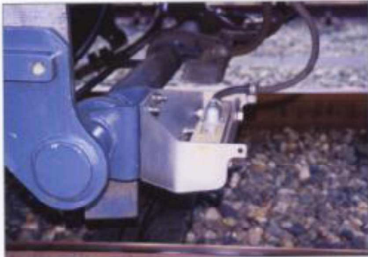
Zo ziet de nieuwe opnemer voor het ATB-systeem er uit. Een dergelijk exemplaar zal ook op voertuigen gemonteerd worden die van ATB-E gebruik zullen gaan maken. Harrie Peters
