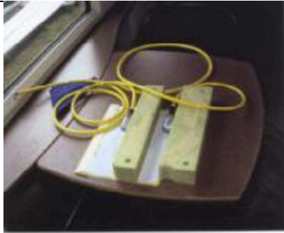
Zo zien de ATB-opneemspoelen er uit in ongemonteerde toestand. Zij lijken niet meer dan een paar kunststofblokken. In werkelijkheid zijn zij in staat om de ATB-signalen die in de spoorstaven geïnjecteerd worden op te nemen en te vertalen in opdrachten voor de machinist.
