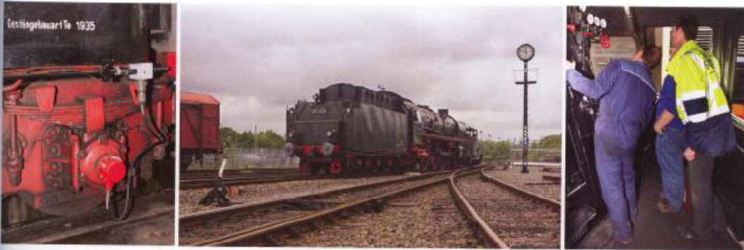
Loks: de kilometerteller is gemonteerd op de eerste as van de tender. De kabel wordt via de lasdoos verbonden met de centrale apparatuur. Midden: met behulp van rangeerloco C4-03 wordt de 01 1075 naar buiten gereden en de waarde die de snelheidsmeter van de loc aangeeft vergeleken met die welke door de ATBE wordt gemeten. Deze moeten uiteraard hetzelfde zijn. Rechts: terwijl de computer instructies geeft aan het systeem kijken de technici van Lloyd's en de SSV toe hoe de reminstallatie van de stoomloc reageert. Bij het testen van het remsysteem wordt, omdat de loc niet onder stoom staat, gebruik gemaakt van perslucht.
