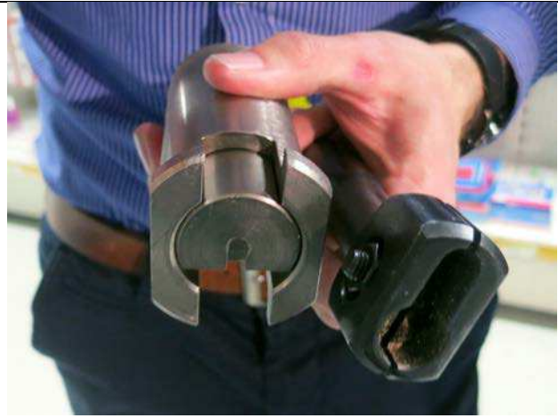
I tasken findes også en "donkraft" til cylindertræk - den grå ting af stål til venstre på billedet.
