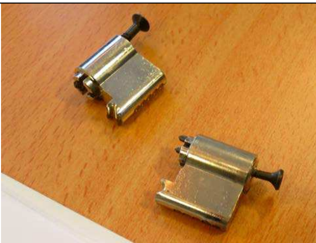
Låsecylindere trukket ud af tyve i Almere. Først skrues der en skrue i låse, derefter bruges "donkraften", som ses på billedet for oven til højre.
