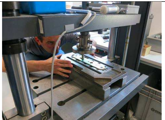
En del tests sker også maskinelt, som her i forbindelse med borettest af låse.
