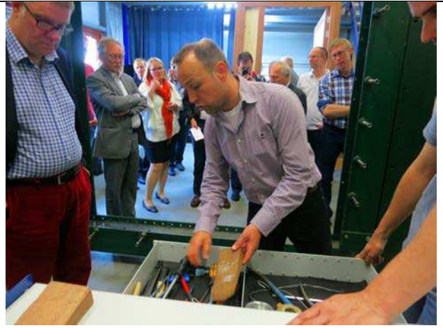
SKG: Her bliver der lukket op for indbrudstyvenes "standardiserede" værktøjskasse. Testen af hele elementer (hele døre og vinduer inkl. karme) sker manuelt med en bestemt opsætning af værktøj.
