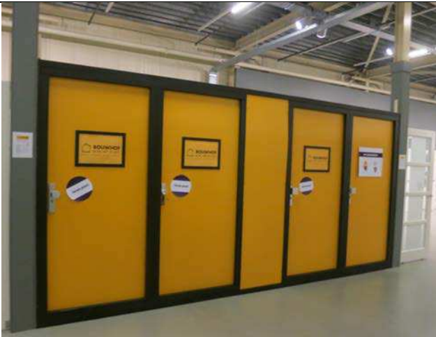
I forbindelse med de nationale indbrudsforebyggelsesuger i 2015, blev disse 4 døre med forskellig skalsikringsstandard opstillet til test.
