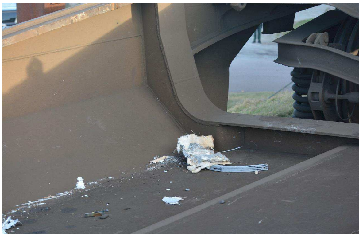
Figur 12: Stumper fra IC4 bagest i forreste lommevogn, hvor sættevognstraileren BK 9024 havde stået.
