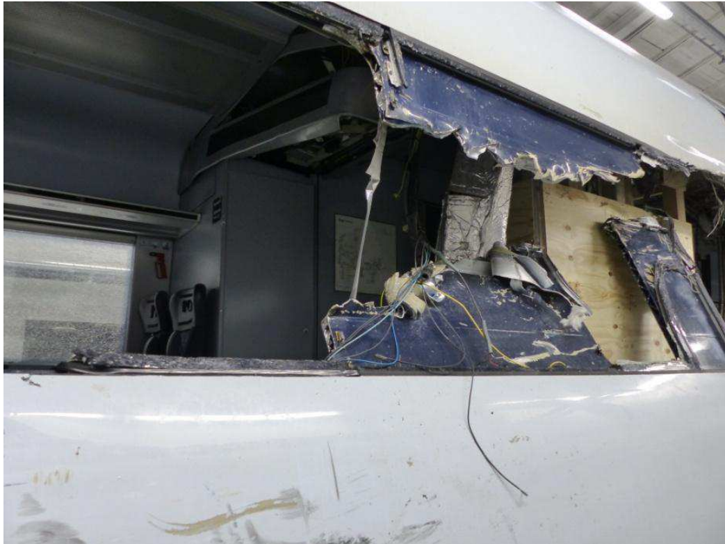
Figur 78: Vognkasseskade i området for indstigningsdør
