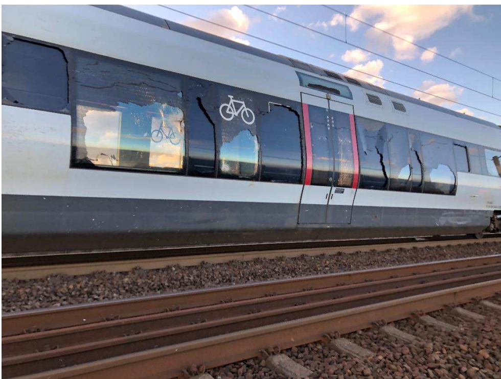
Figur 87: Glasskader på venstre side
