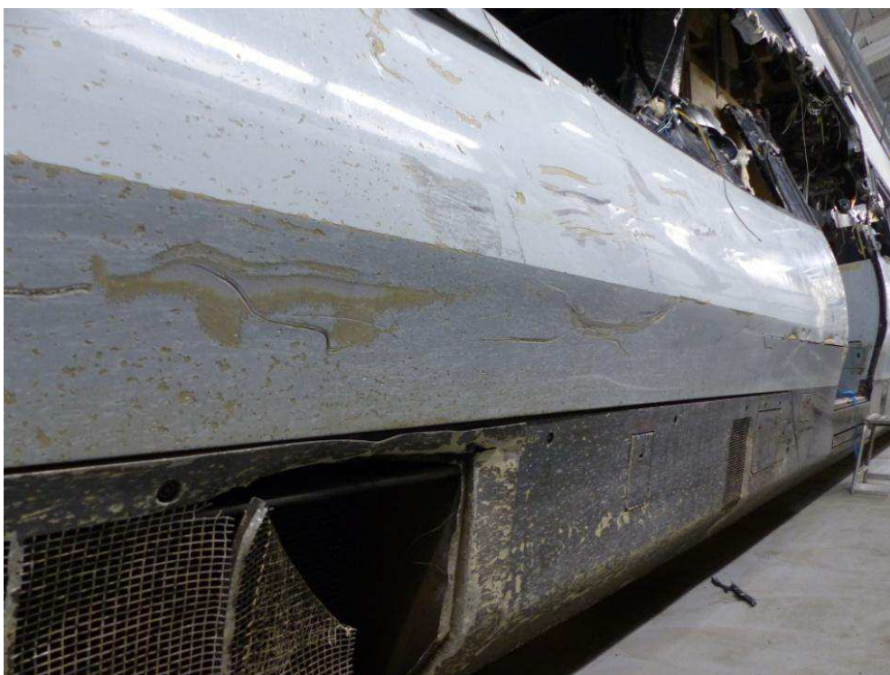
Figur 83: Overfladeskader, forreste vogns venstre side
