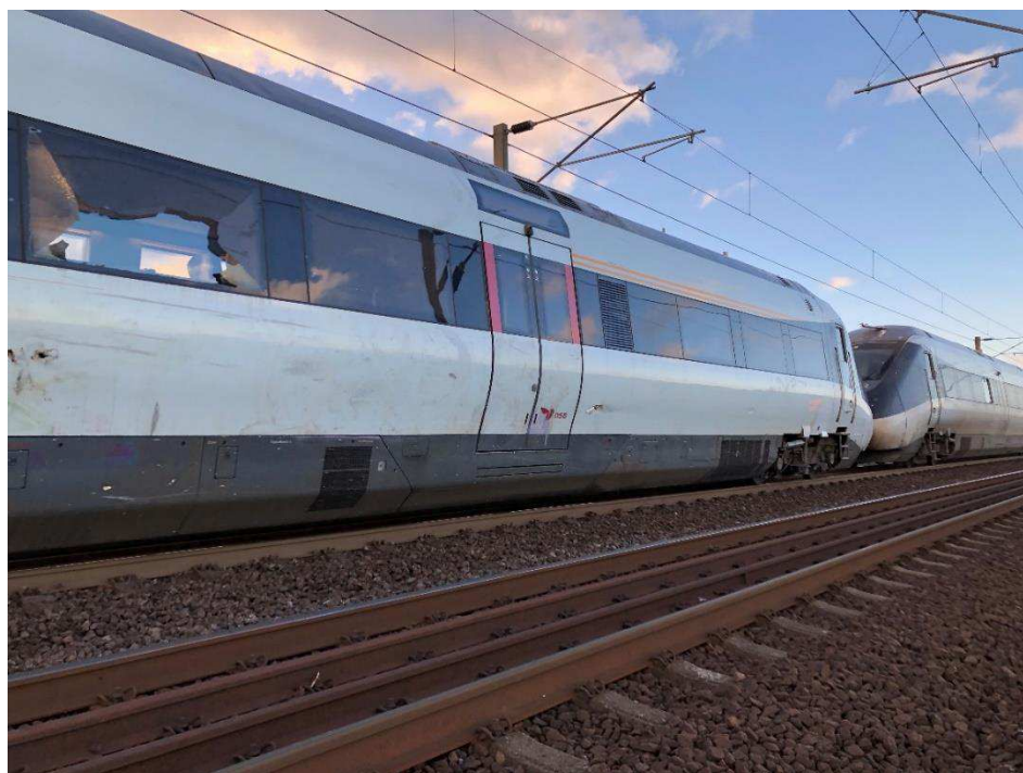
Figur 89: Skader på bageste del af vogn 4
