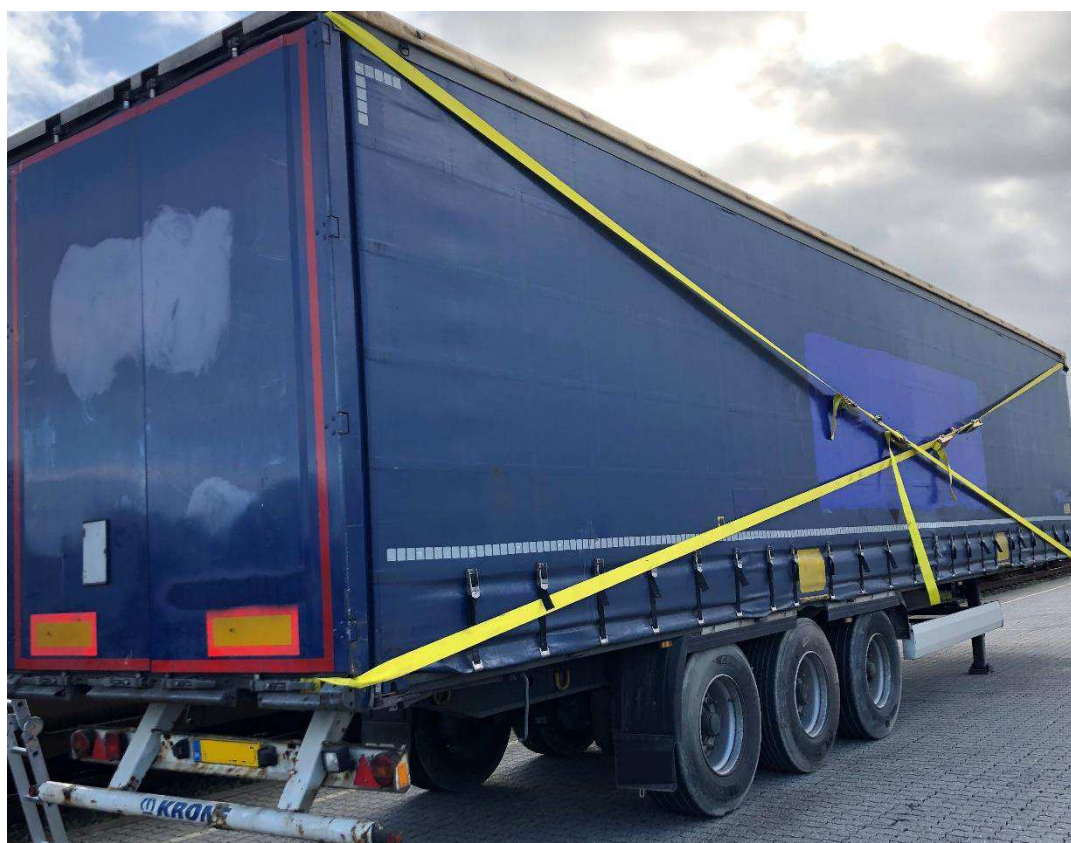
Figur 65: Opstilling til trækforsøg
