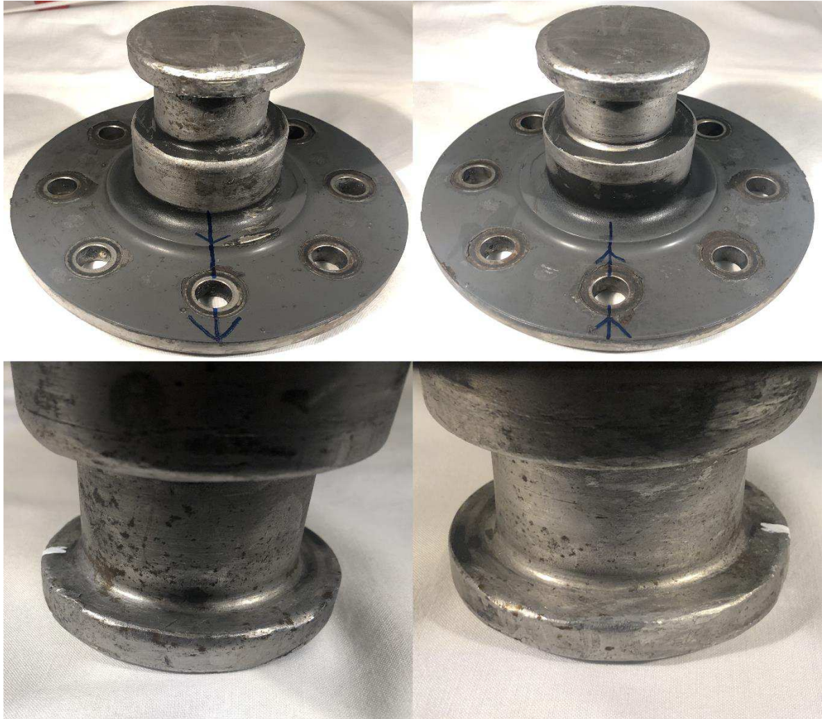
Figur 64: Hovedbolt fra ulykkestraileren. Pile hhv. hvide streger markerer fremad i køreretningen
