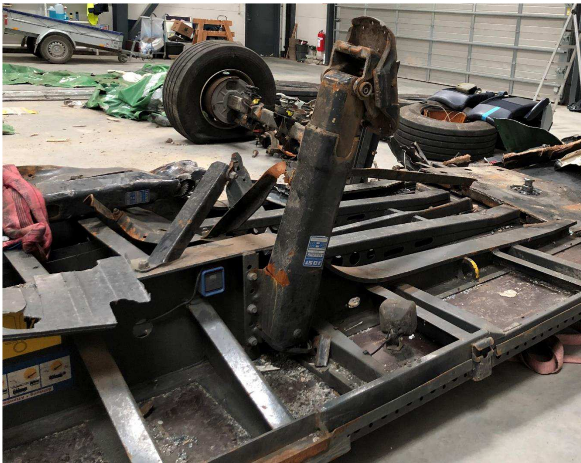
Figur 63: Beskadiget venstre støtteben
