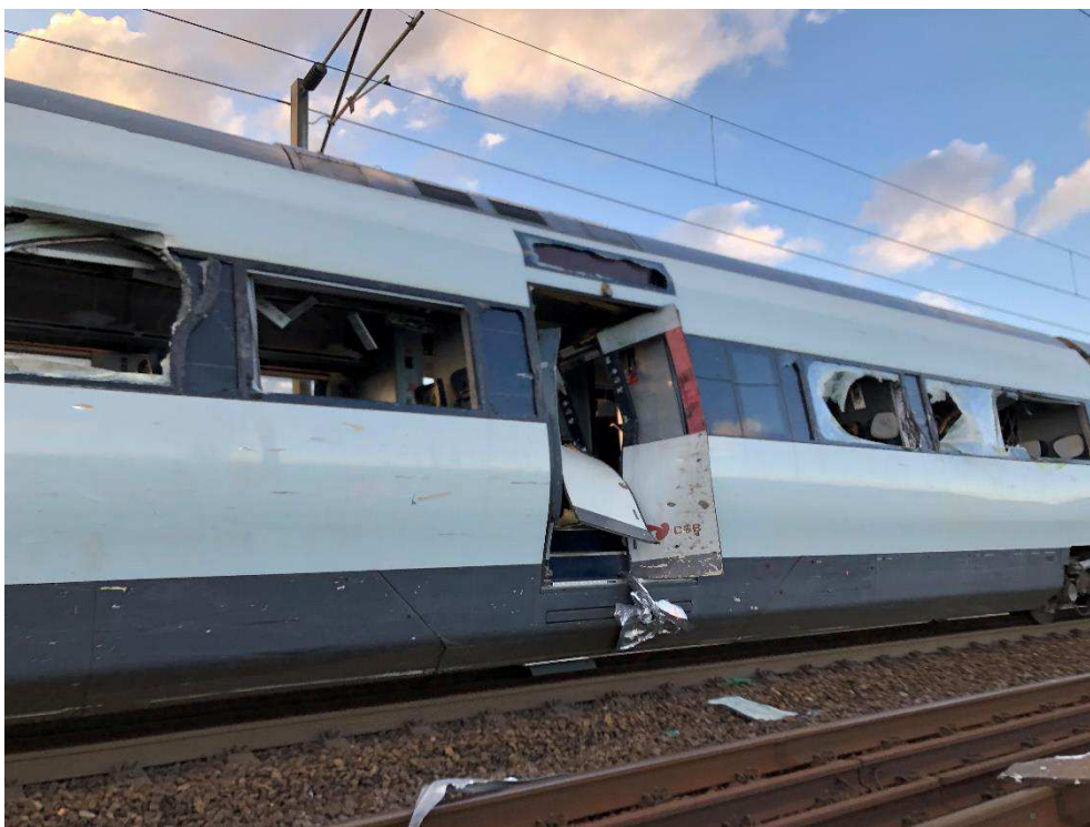
Figur 85: Bageste del af anden vogn. Skader på indstigningsdøre og vinduesstolper
