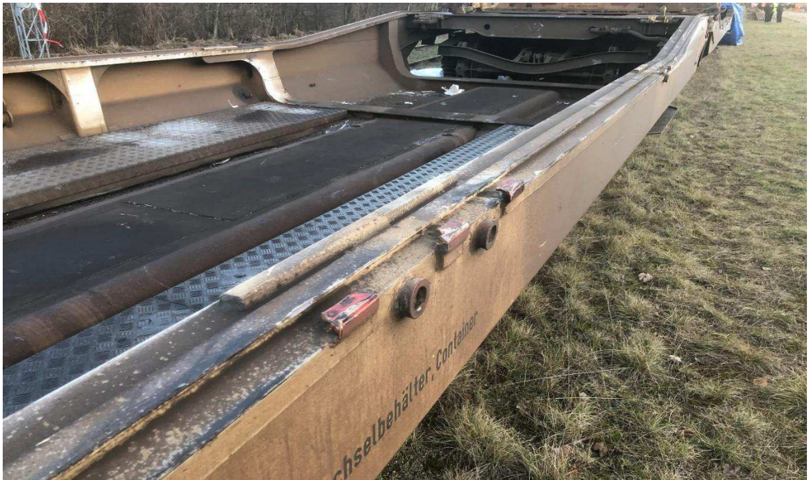
Figur 37: Skader på lommevognen
