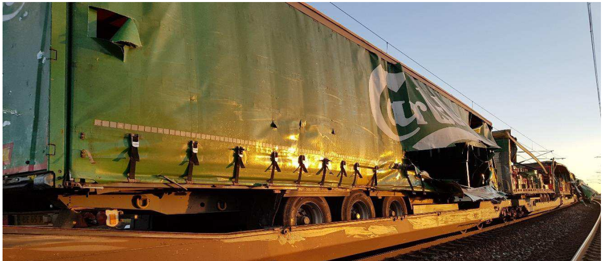
Figur 41: Skader på sættevognstrailer i position 2 - samme vogn som ulykkestailereren
