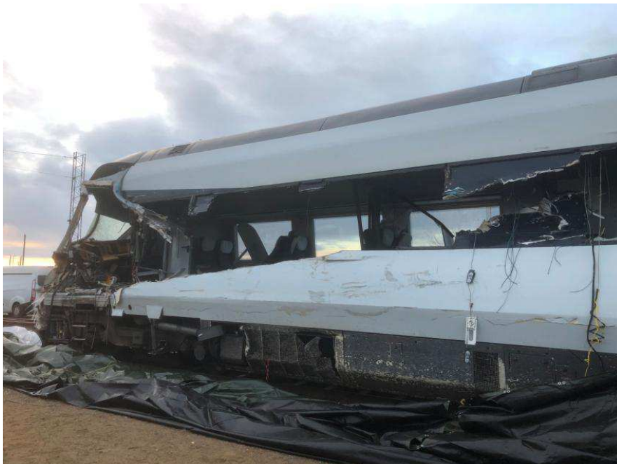
Figur 77: Skader på venstre side, IC4
