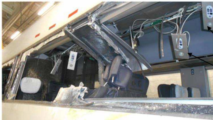
Figur 103: Nedfaldne lyspaneler under bagagehylde
