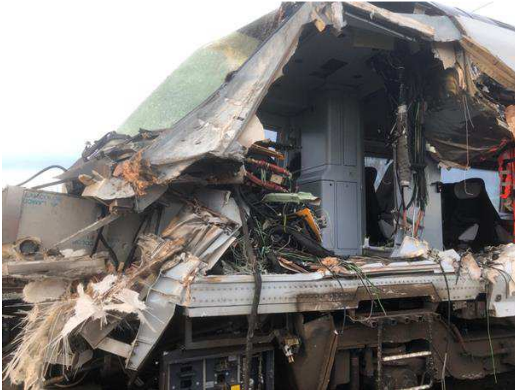
Figur 76: Skader på venstre side, IC4
