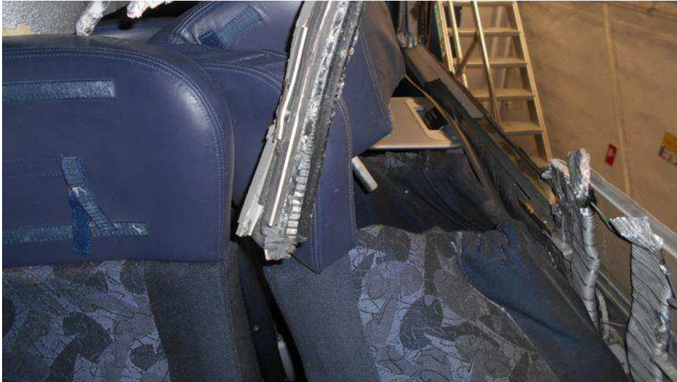
Figur 110: Vinduesstolpe slået ind ved sæde 155
