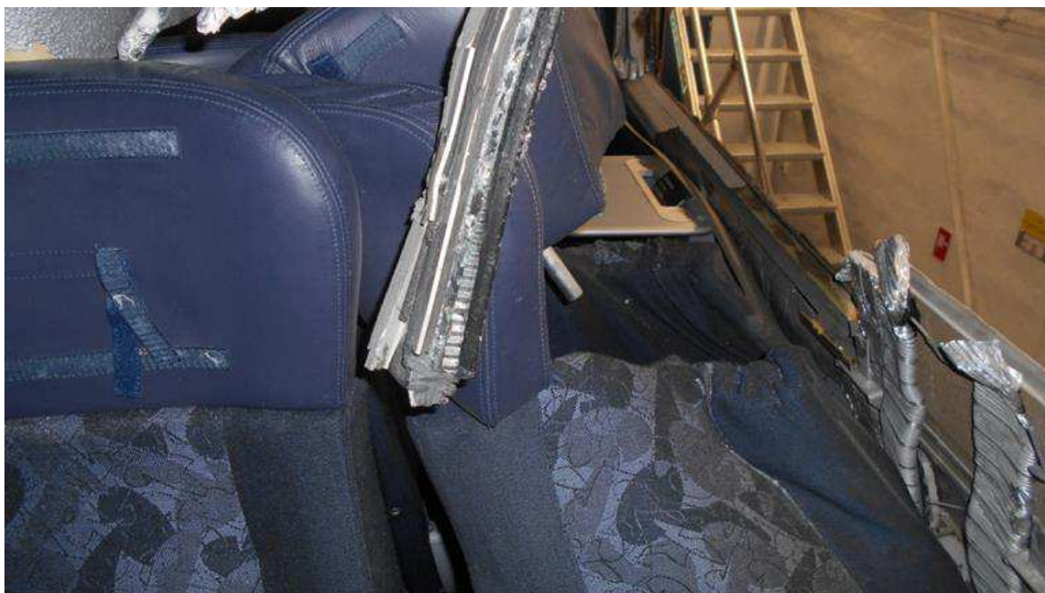
Figur 106: Skader på sæde ved plads 155
