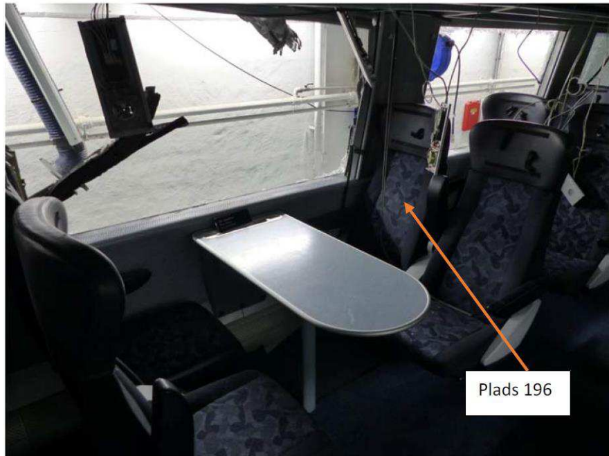
Figur 111: Sæde 196 - deformeret vinduesstolpe
