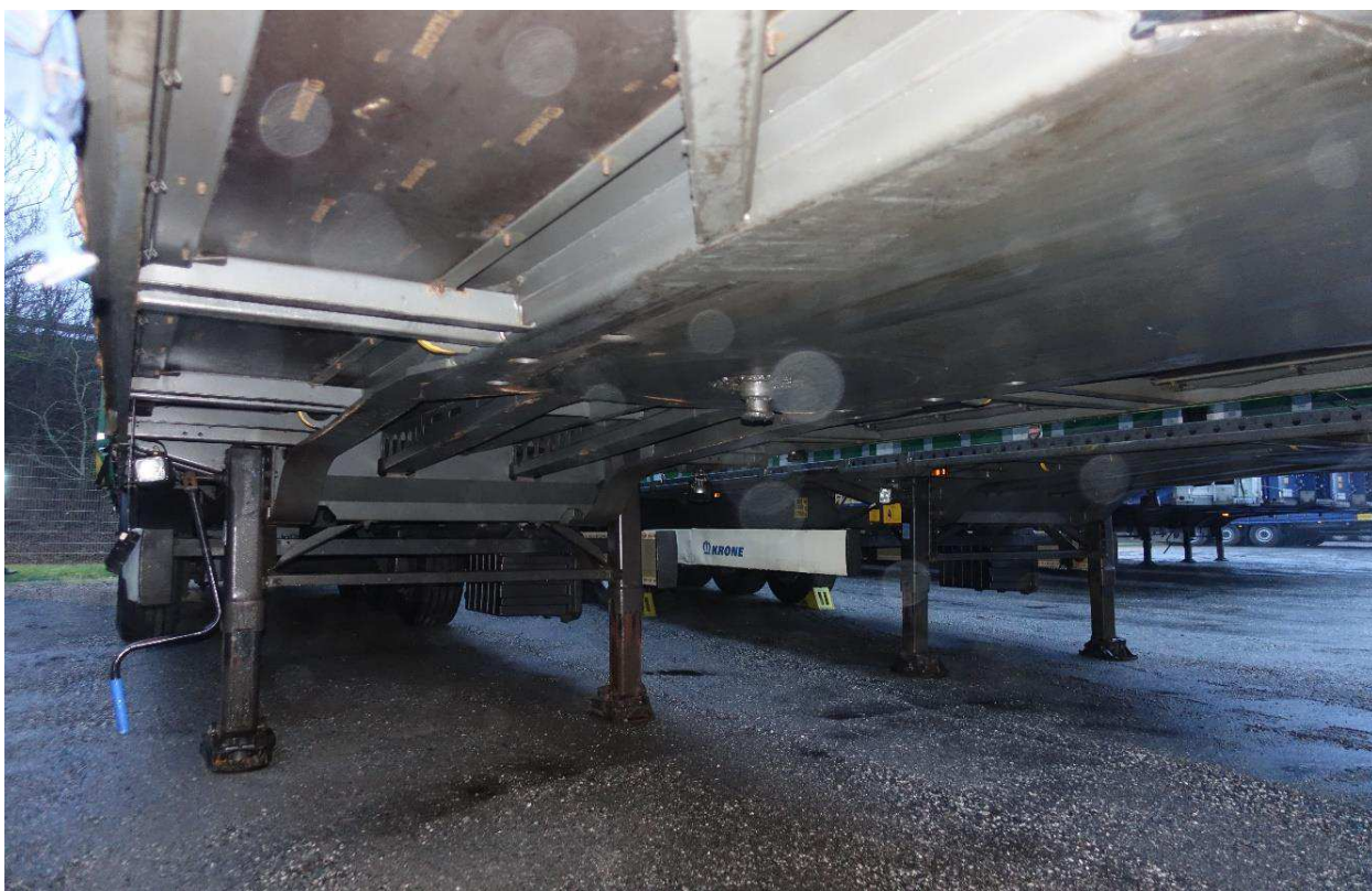
Figur 14: Opbygning af trailerlad
