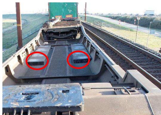
Figur 20: Gulv hævet 155 mm
