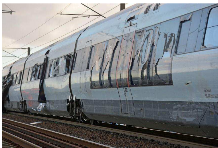
Figur 9: Km 127,40. Skader på L 210. Traileren ses forrest til venstre. Herefter anden og tredje vogn
