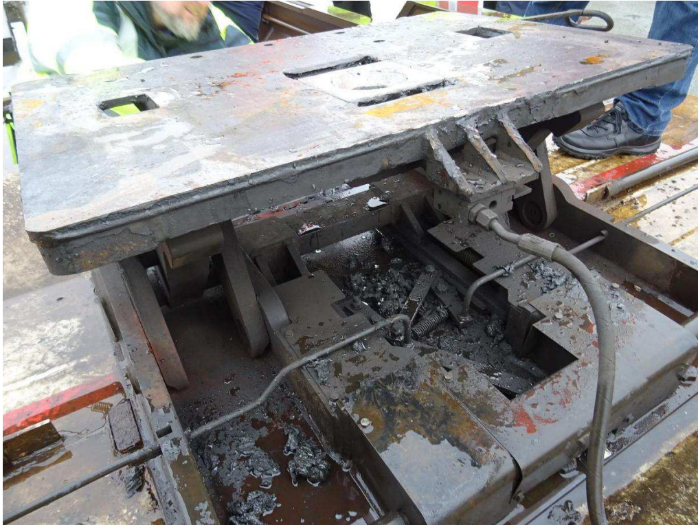
Figur 49: Skammelforkant kort efter ulykken
