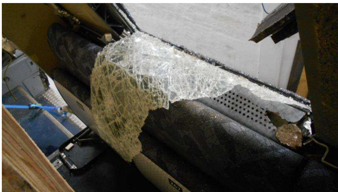
Figur 94: Del af indvendig lamineret glaslag fra vindue i vestibulen i vogn 1
