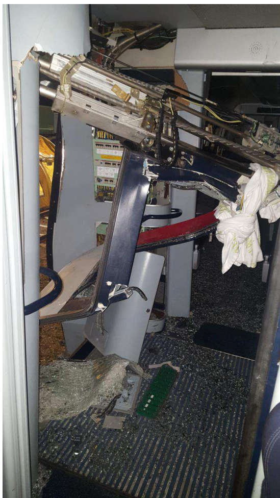
Figur 107: Vogn 2. Skader på indstigningsdøre, venstre side
