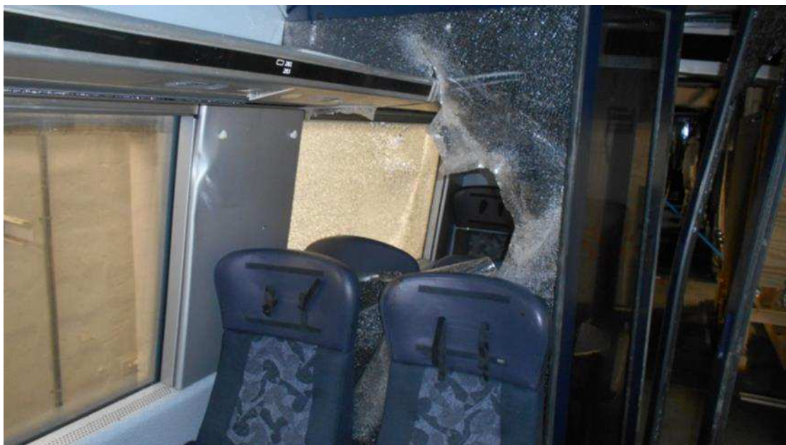
Figur 93: Glasskillevæggen bag pladserne 281 og 283 -knust / krakeleret
