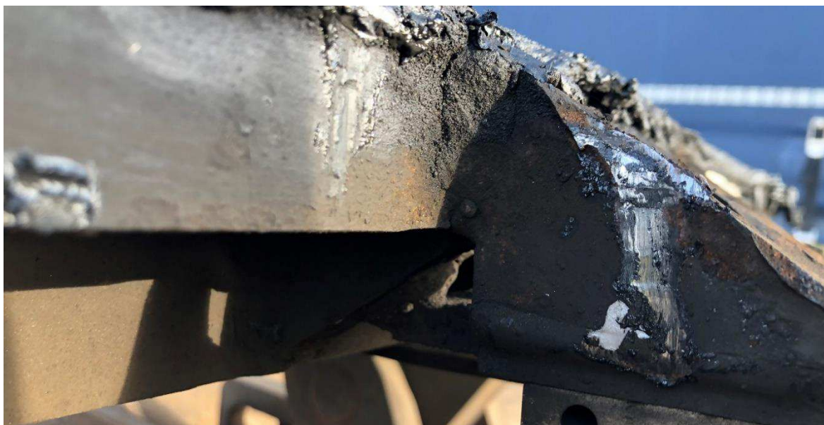
Figur 67: Træktest. Mærker efter hovedbolt foran skammel
