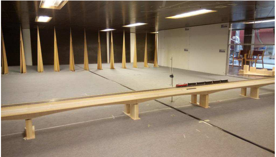
Figur 68: Bromodel med togmodel i vindtunnel
