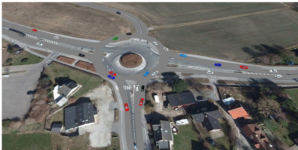
Figur 12 Simulering af trafikken i VISSIM, projektforslag for eftermiddagstrafik i 2033.
