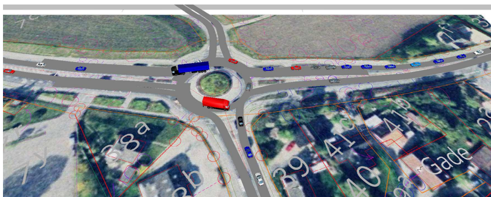
Figur 11 Simulering af trafikken i VISSIM, eksisterende udformning eftermiddag 2033.
