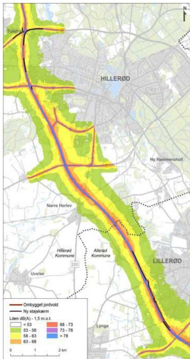
Figur 7-14 Støjniveauekonturkort, projektforslag 2025 +10% ÅDT med valgt støjskæmning og støjreducerende asfaltbelægning.
