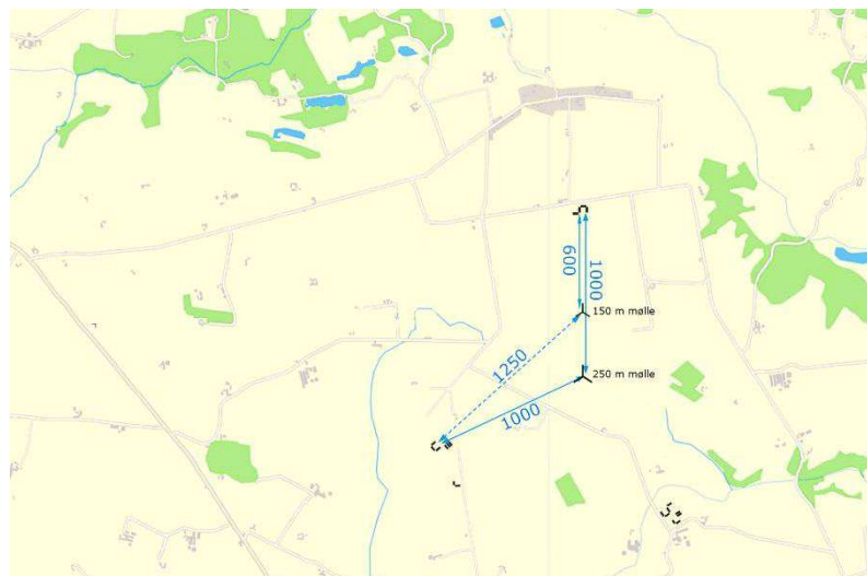
Figur 6-19. Illustration af et teoretisk eksempel, hvor en 150 meter høj vindmølle er placeret 600 m fra nærmeste nabobeboelse og 1.250 m fra anden beboelse. Hvis den 150 meter høje vindmølle skal udskiftes med en vindmølle på 250 meters højde, skal møllen flyttes 1.000 meter væk fra nærmeste nabobeboelse. Vindmøllen er i eksemplet flyttet mod syd, og kommer derfor til at ligge tættere på den anden beboelse end den 150 meter høje vindmølle gjorde. Den visuelle påvirkning vil derfor være større, selvom minimumsafstanden er overholdt.
