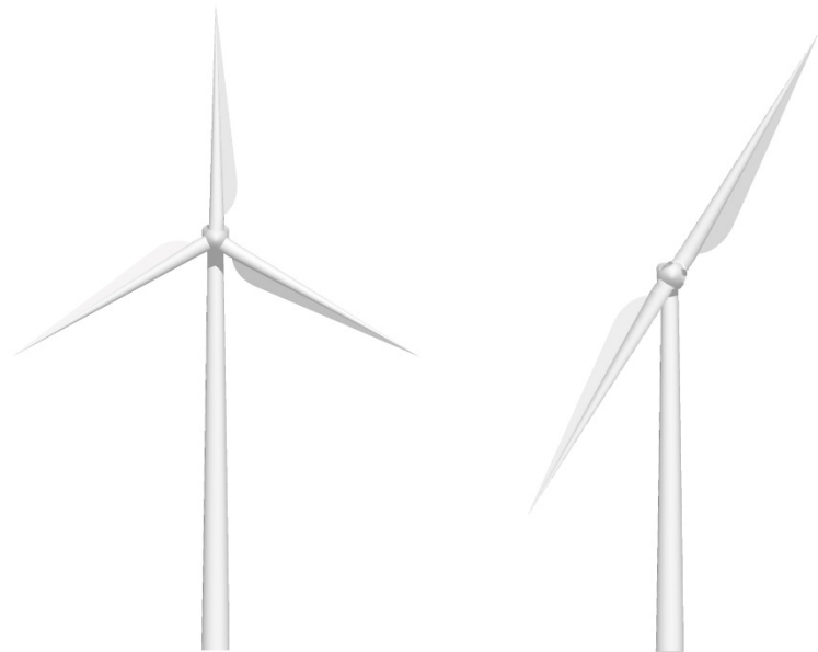
Figur 6-5. Eksempel på to- og trevingede vindmøller.
