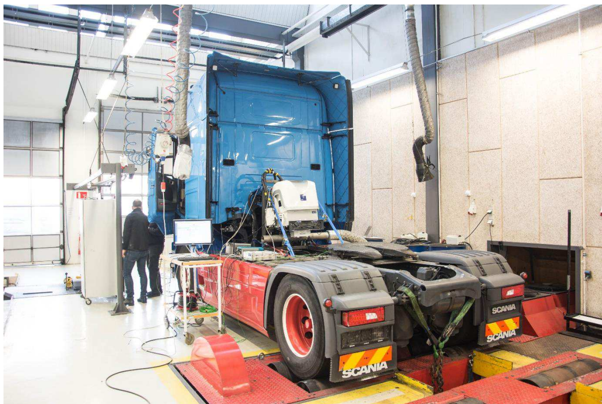
Figur 16: Lastvognen på rullefelt på Teknologisk Institut i Aarhus. På foto er bilen klargjort til test. Den hvide boks bag førerkabinen er det mobile PEMS emissionsmåleudstyr.
