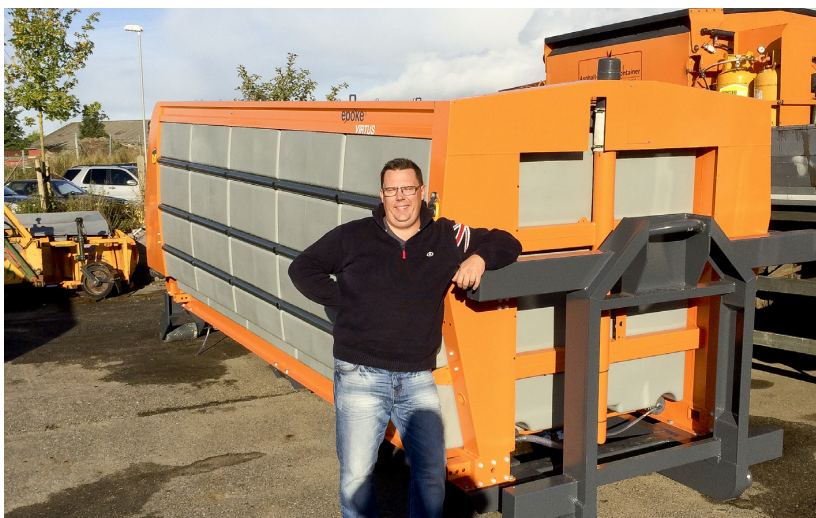
Figur 1. 12½ m³ ny saltlagespredere klar til i fuldtlastet tilstand at trækkes op på lastbilen
