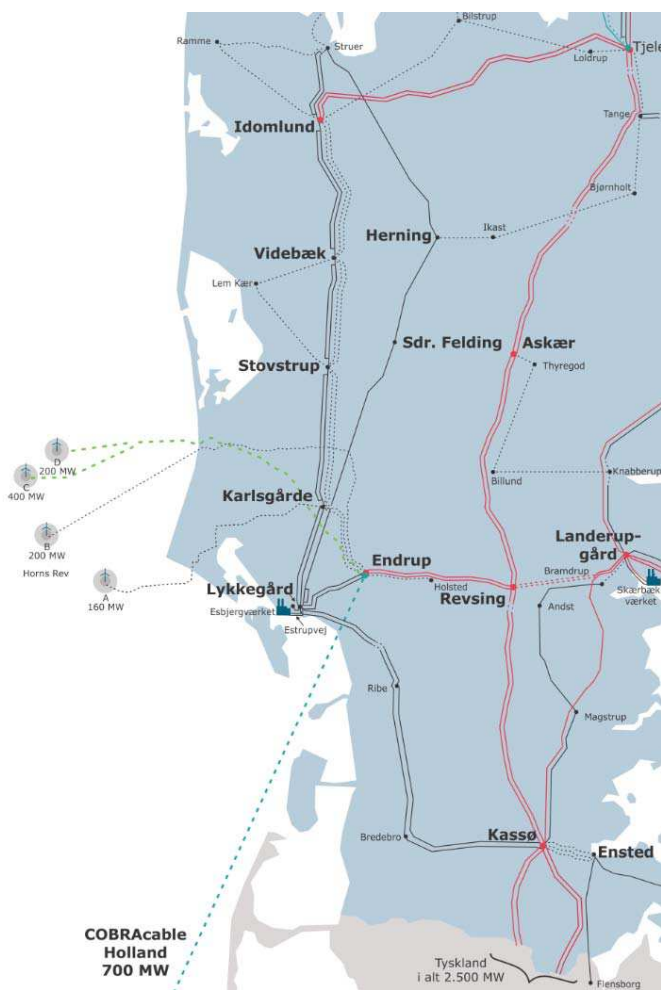
Figur 3 Netstruktur 2035 – to kabler og eksisterende 150 kV-luftledning.
