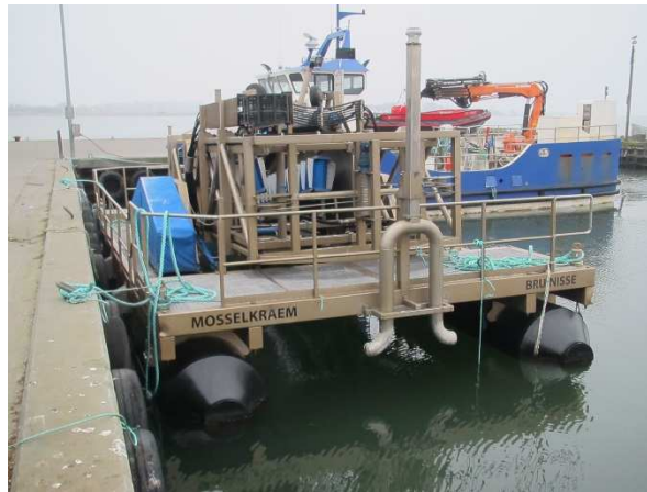
Figur 3.3 Høstbælterne er de blå bælter med hvide lameller, der her ses i midten på maskinen. Når de ikke er i brug, ligger de i vandret position på dækket af maskinen. Kilde: Hjarnø Havbrug
