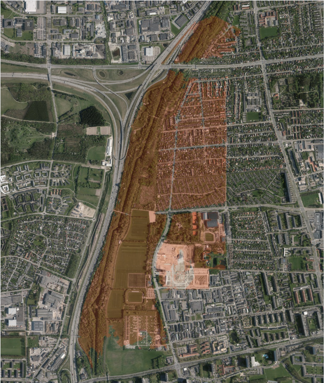
En støjskærm vil reducere støjen med op til 7 dB i det brune område. Kilde: beregninger fra Rambøll og Rødovre Kommune
