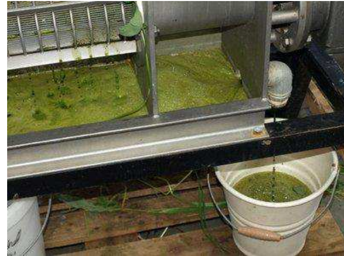
Skruepresse, skiller protein-juice fra fiber pulp
