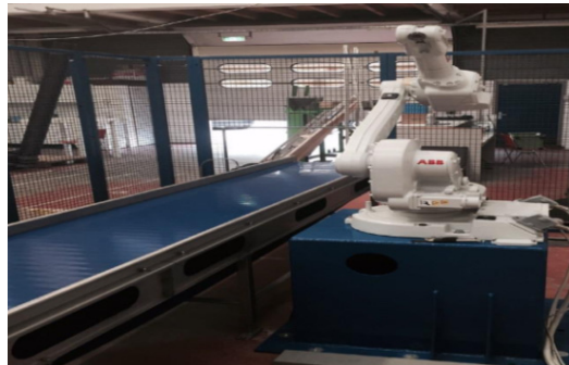
Kamerabaseret detekterings- og sorteringssystem, © Zeevisserijbedrijf Snoek bv, 2014.
