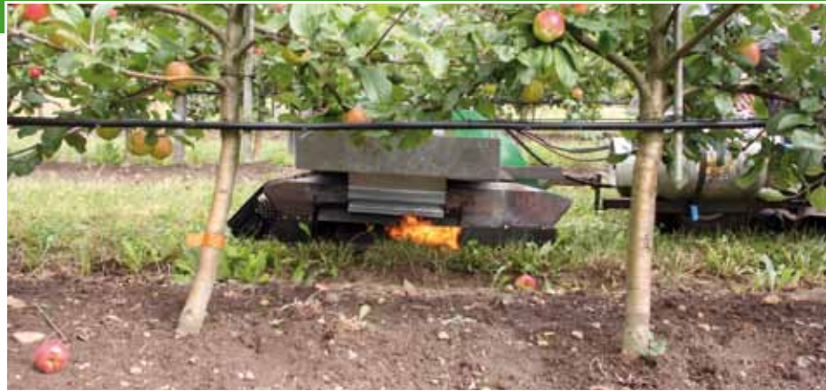
Foto 6: Ukrudtsbrænderen demonstreret i æbleplantage ved Åbent hus hos Aarhus Universitet i august 2014. 800 °C varm luft blæses ind i træerækken og hindrer fremspiring af nyt ukrudt
