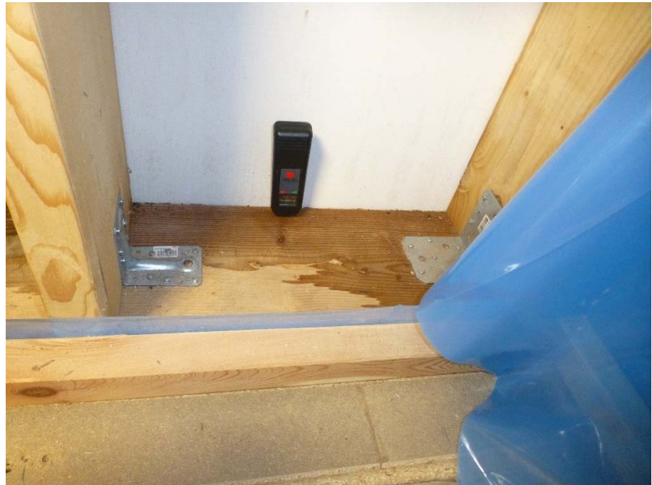
Figur 11: Opfugtning af fodrem med MgCl_2 -holdigt vand
