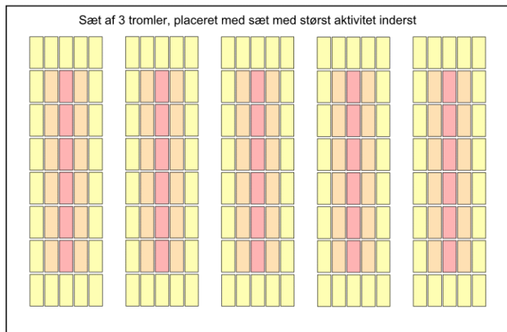
Figur 2, Placering af tromlesæt i hal
