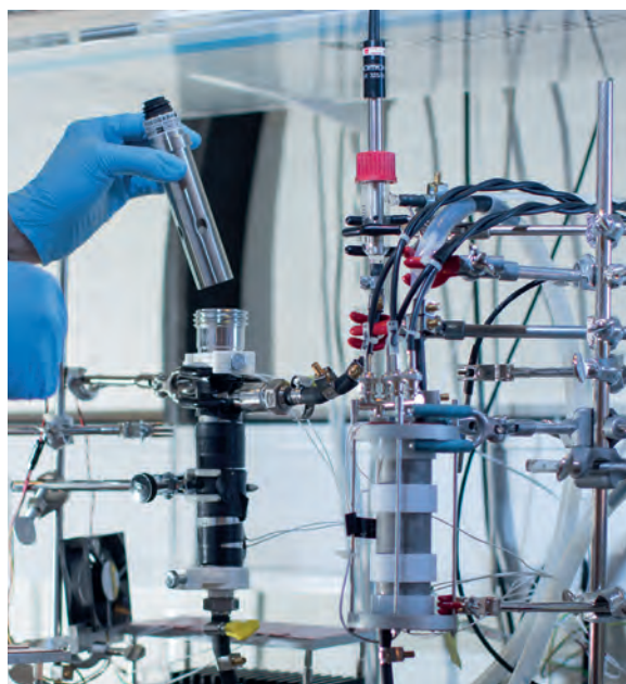
Opstilling til måling af ledningsevne af rent vand udført af DFM. Foto: DFM
