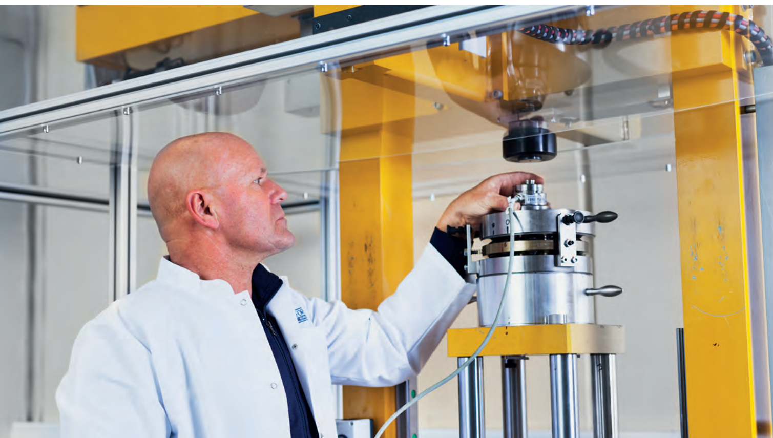
FORCE Technologys referencemåler bliver primært benyttet til kalibrering af målere, der måler kraft (krafttransducere). Foto: FORCE Technology
