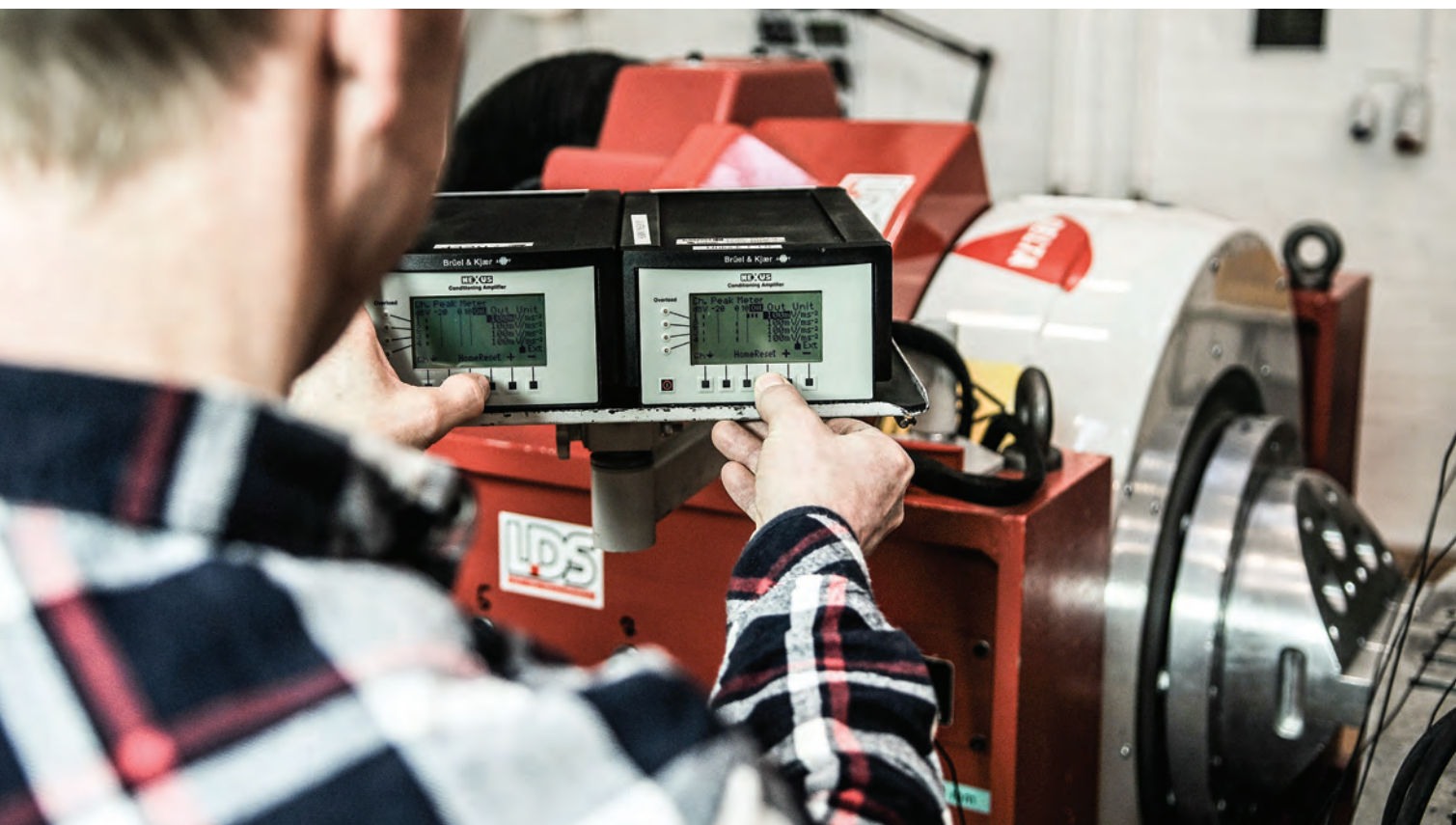
Ved en vibrationstest hos DELTA bliver et objekt eller et produkt placeret i en maskine, der simulerer påvirkningerne fra omgivelserne i den virkelige verden. Foto: DELTA
