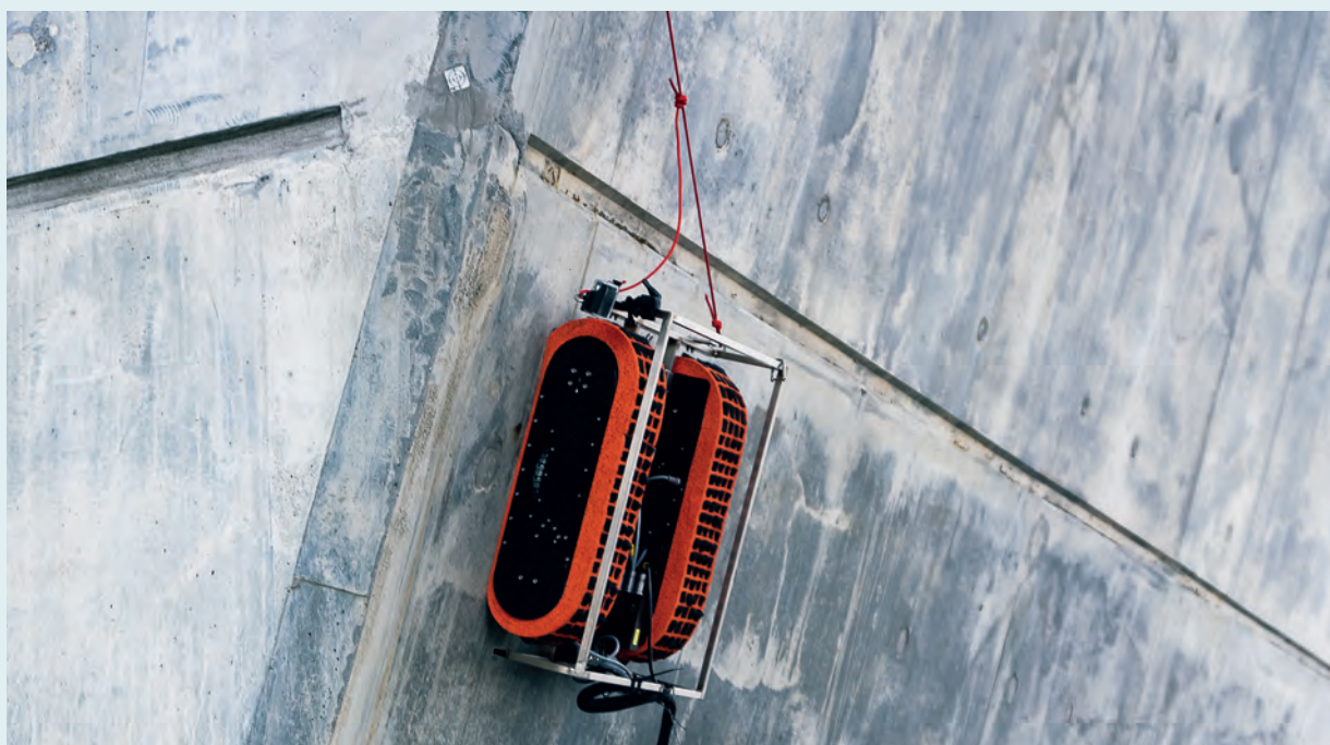
FORCE Technology har i regi af RoboCluster udviklet en robot på larvefødder, der kan inspicere steder, hvor mennesker har svært ved at komme frem. Foto: FORCE Technology
