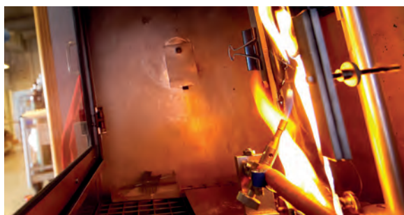
Der udføres brandtest af produkter og materialer i DBI's brandlaboratorium. Foto: DBI
