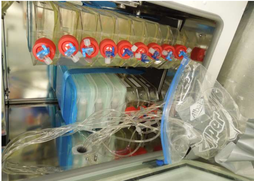
Vævsflasker i en inkubator: Vævsflaskerne indeholder cellerne og de næringsstoffer de skal bruge for at overleve.
