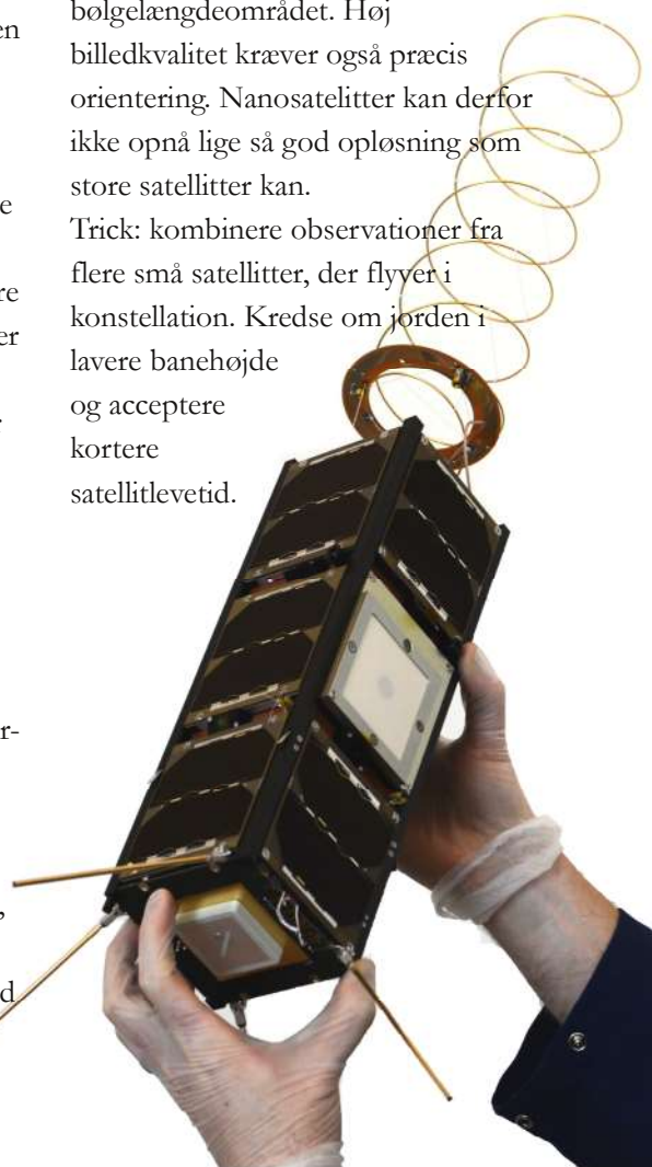
GOMX-3 er en 3U Cubesat - fylder 3 standardmoduler under opsendelse. Vægtklasse: Nanosatellit. Foto: GomSpace.
