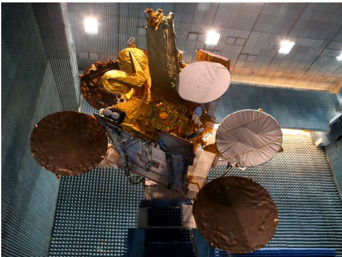
Figur 1 Eutelsat-9B satellitten under RF-test hos Airbus Defence and Space, Frankrig, er et eksempel på en satellit, hvor antennerne er designet med TICRAs software. Copyright: Airbus Defence and Space SAS. Fra: www.esa.int .
