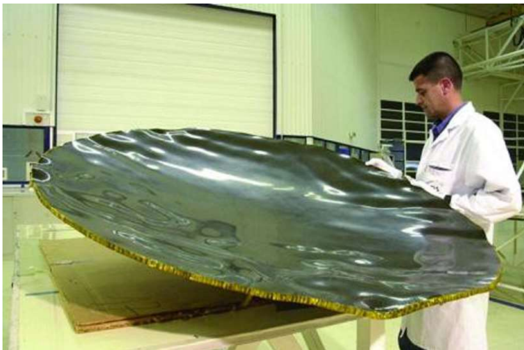
Figur 2 Antenne med bulet reflektoroverflade designet af EADS Astrium.
