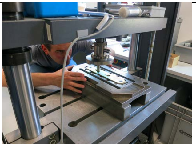
En del tests sker også maskinelt, som her i forbindelse med boretest af låse.
