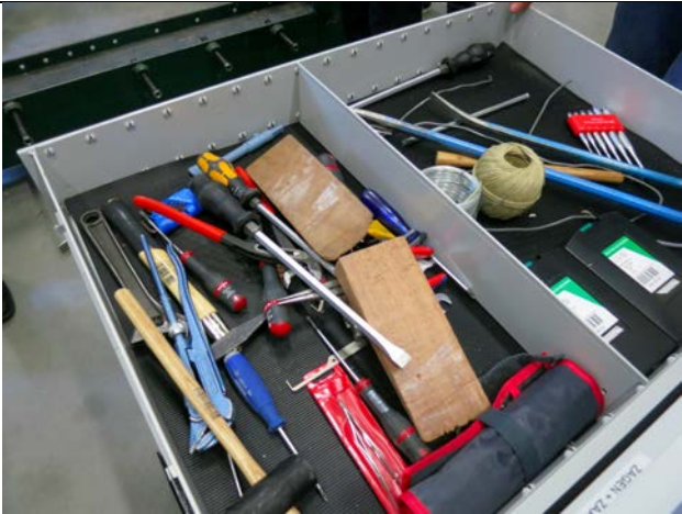
SKG: Her er nogle af tyveriværktøjerne, som bruges til tests, bl.a. en stor skruetrækker og kiler.
