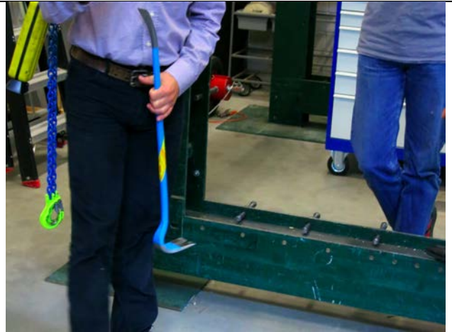
SKG: Koben bruges også - til sikringsklasse 3 tests (5 minutter).
