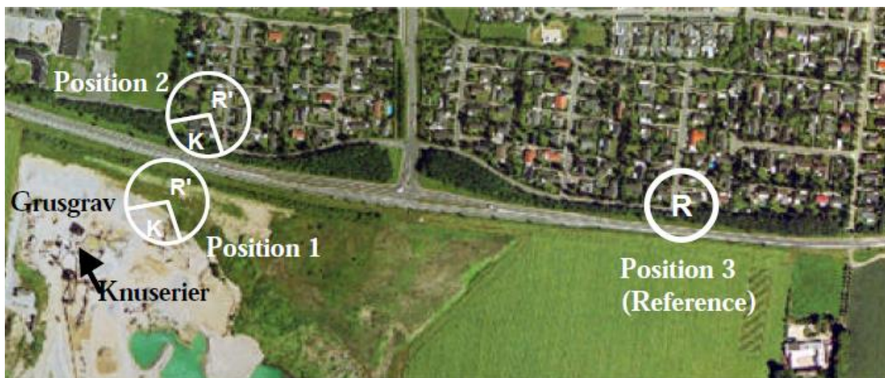
Figur 9 - Måling af støvfald opdelt efter vindretning fra grusgraven og fra andre vindretninger på position 1 (ca. 150 m fra knuserier), position 2 (ca. 220 m fra knuserier, beboerområde hvorfra støvgener rapporteres) og position 3 (gennemsnit for alle vindretninger i referencepunkt, R): Maj måned 2002.
