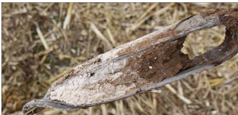
Figur 1. Boreprøve med grænsen mellem moræneler og kalk i 2,2 meters dybde under en mark nord for Thisted.
