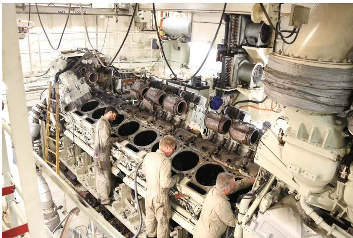
Reparation af hovedmotor på ESBERN SNARE af ABSALON-klassen 2014
