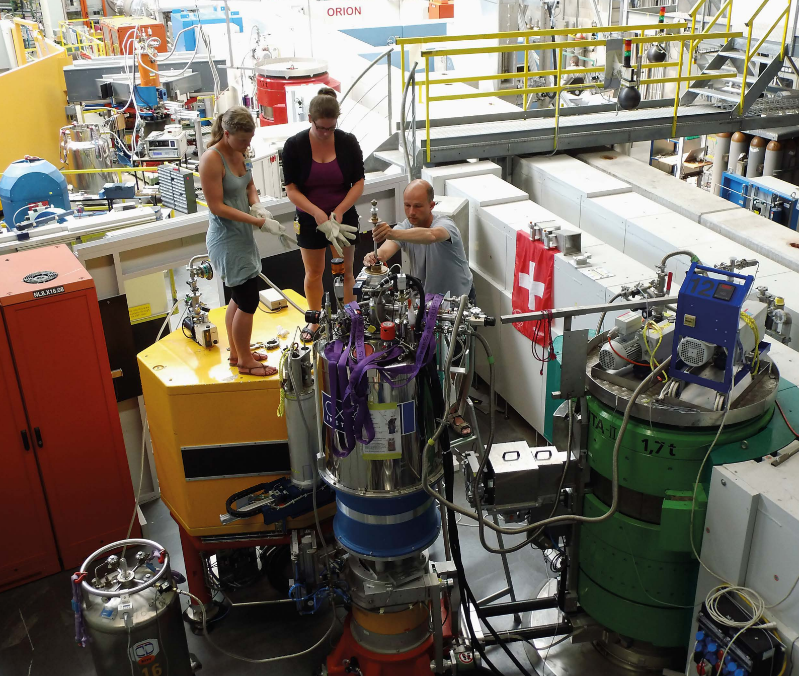
Forsigtigt nedsænkes en krystal af det magnetoelektriske materiale \text{LiCoPO}_4 i en 15 Tesla magnet på det dansk-byggede RITA-II tre-akse spektrometer, som står på Paul Scherrer Institutet i Schweiz. Neutronerne kommer ud af den grønne cylinder til højre, og detekteres i den gule analysatortank til venstre.
