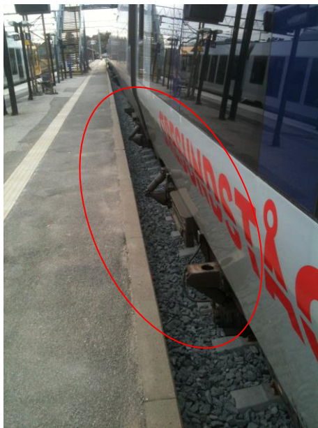
Figur 3. Øresundstog litra ET Støddæmperarrangement på udvendig side af bogier imod perronkant.
