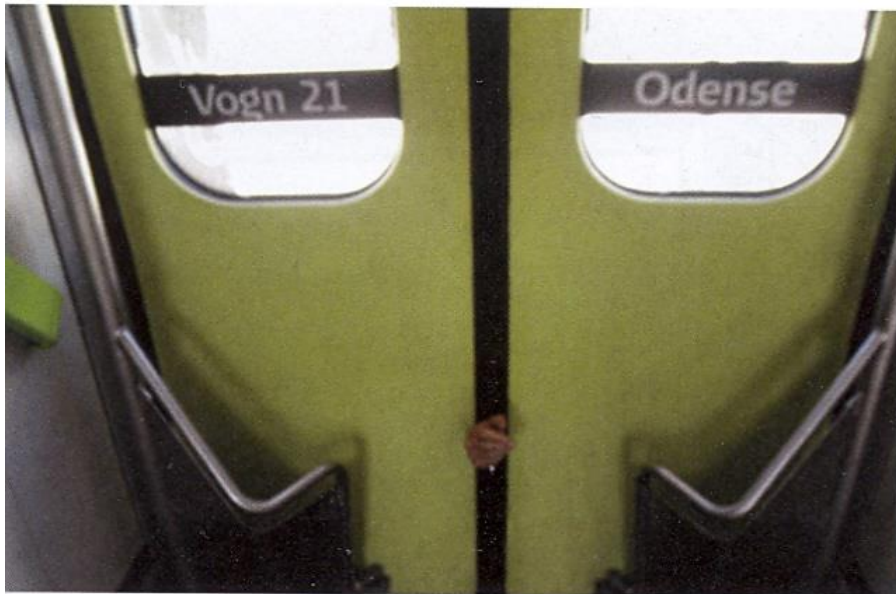
Figur 5 Fastklemmt hånd i ER-togsæt
