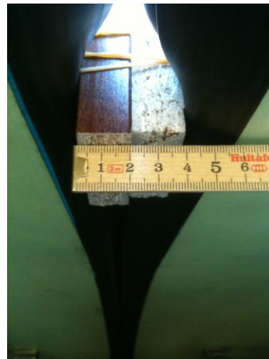
Figur 7 Fastklemmt objekt på 4,5 cm i ER-togsæt
