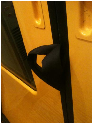
Figur 6 Fastklemte stropper fra en rygsæk i ET-togsæt
