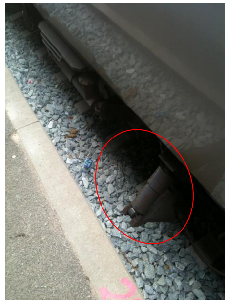
Figur 4. Øresundstog litra ET Støddæmperarrangement på udvendig side af bogie.
