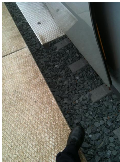
Figur 2. Afstand mellem ET-togsæt og perronkant (bemærk den sorte sko).
