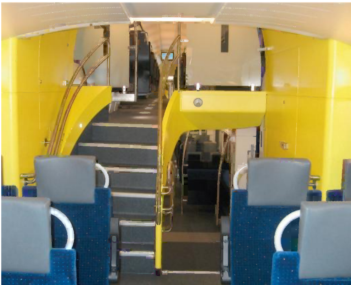
Figur 14.13 – Stadler KISS-tog. Billedet viser de indvendige forskelle i højdeniveauer. 38
